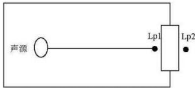
图 6.2-1 室内声源等效为室外声源图例
