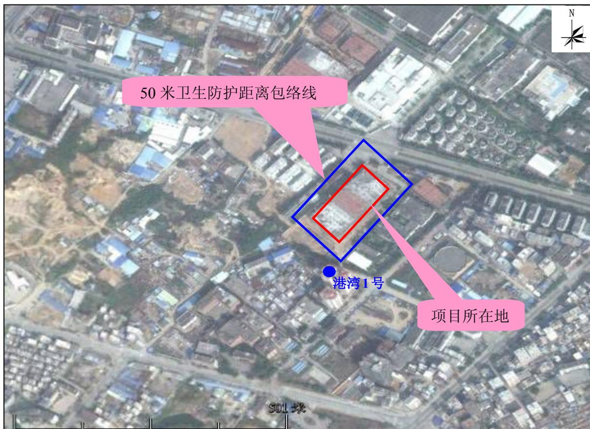
图 7-2 项目卫生防护距离包络线示意图
