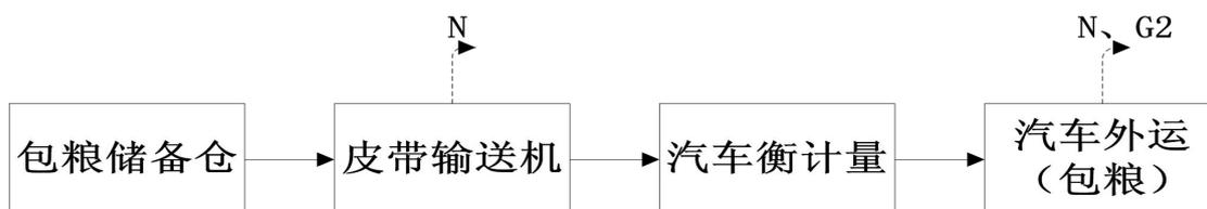
注：G1：粉尘 G2：汽车废气 S1：一般固废 N：噪声
