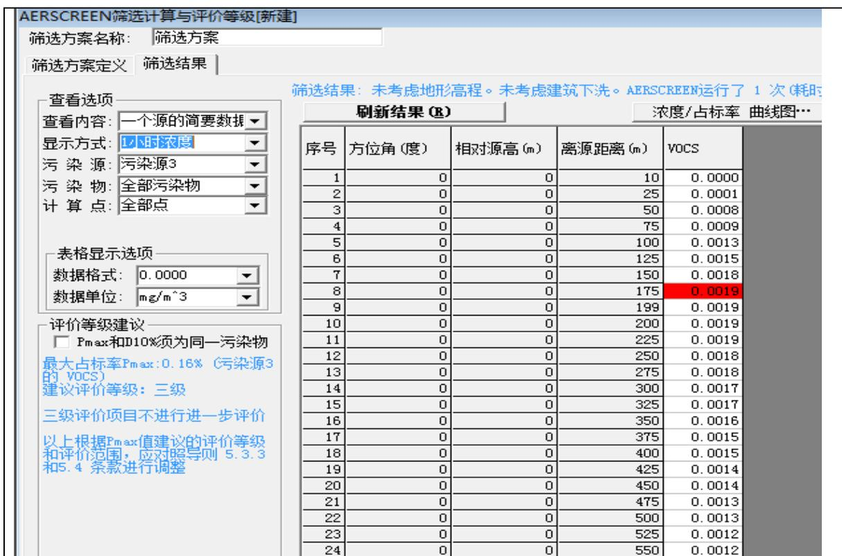
图 6-2 排气筒 1#总 VOCs 筛选计算结果
