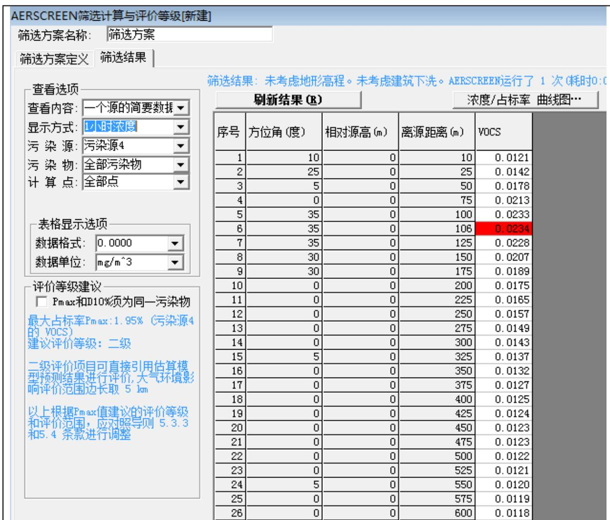
图 6-3 无组织总 VOCs 筛选计算结果
