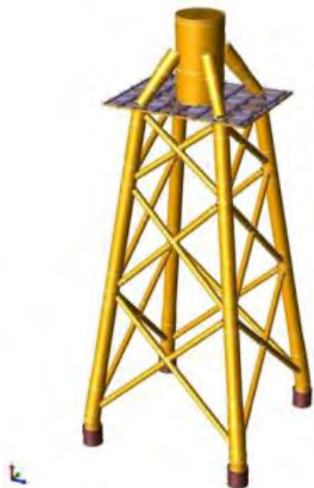
图2-19 四桩导管架基础计算模型图
