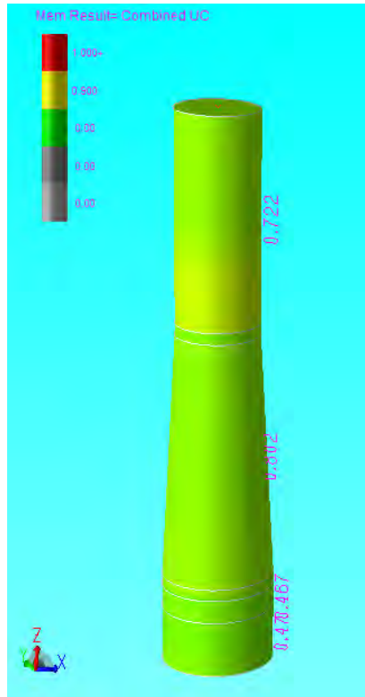
图2-21 单桩基础计算模型图
