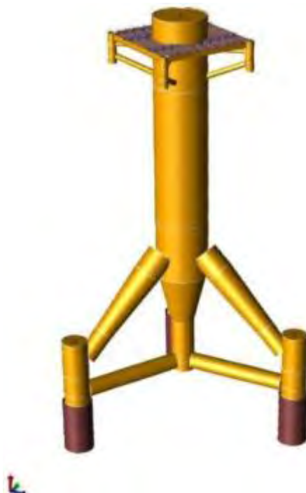
图2-20 水下三桩基础计算模型图
