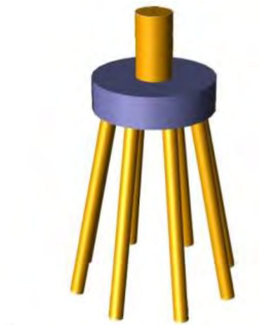
图2-18 高桩承台基础计算模型图
