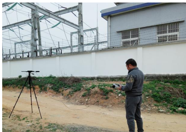
变电站围墙外 (工频电磁场监测)
