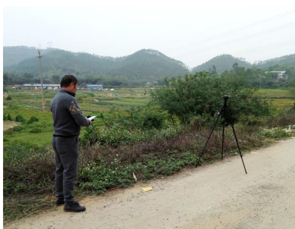
变电站围墙外 (工频电磁场监测)
