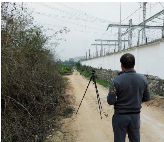
变电站围墙外 (工频电磁场监测)
