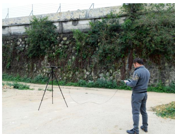
变电站围墙外 (工频电磁场监测)
