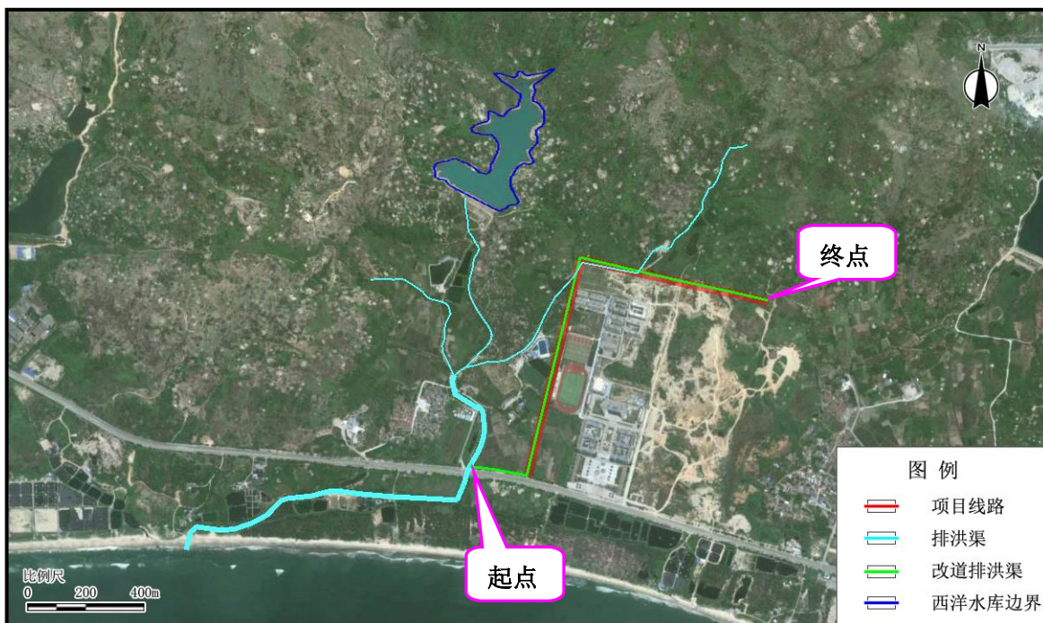
2.4-5 排洪渠总体走向布置示意图
