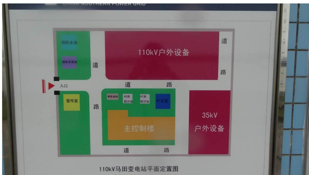
图 4 110kV 马田变电站总平面布置图
