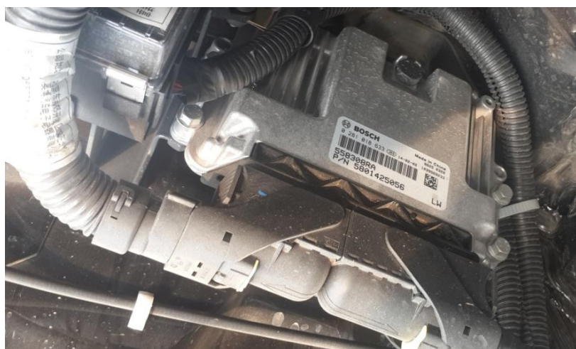
图2 ECU 电控单元
