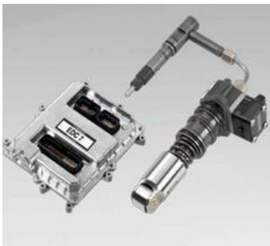
图4 电控单体泵及 ECU
