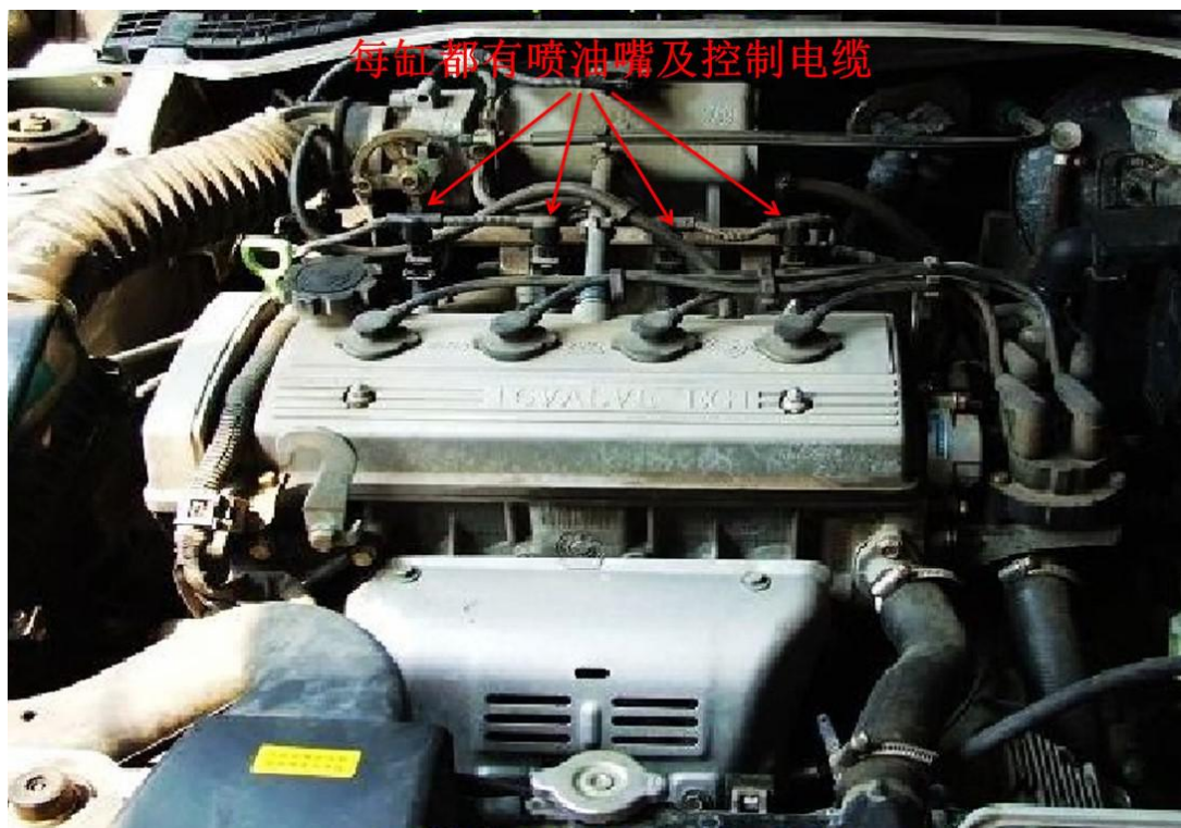
图 2 典型电喷汽油发动机的外观结构
