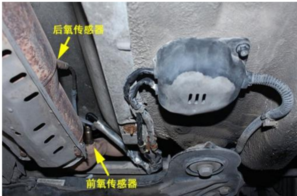
图 4 典型电喷发动机的前、后氧传感器布置位置
