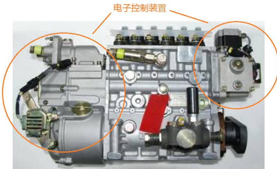
图 1 电控直列泵的控制装置及控制电缆
