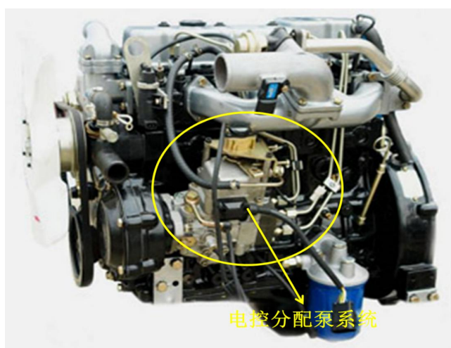
图3 常见电控分配泵系统的外观结构
