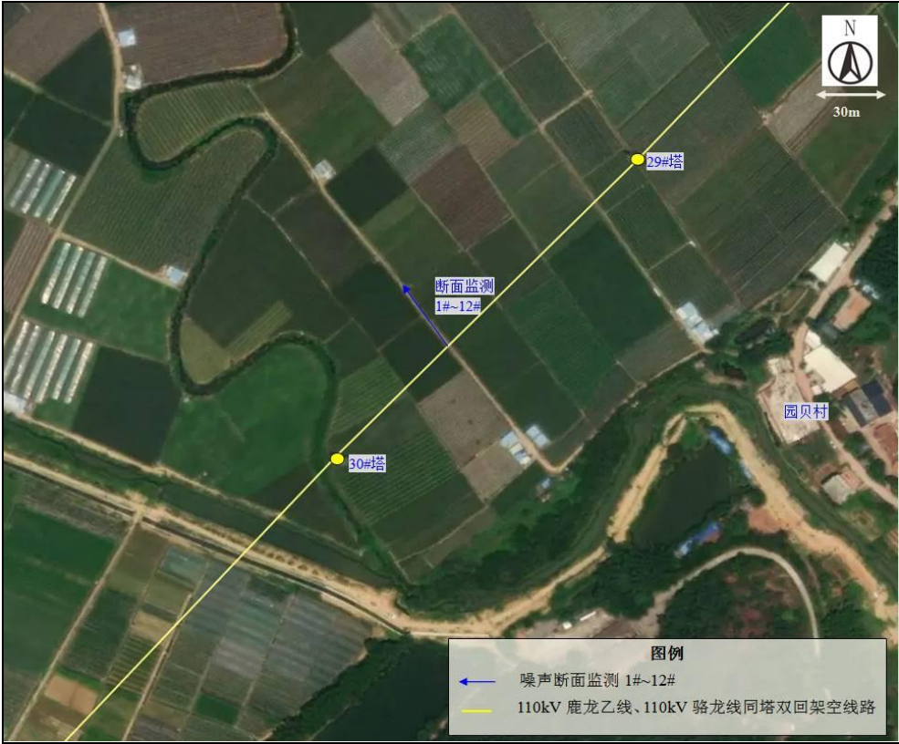
图 4-5 双回架空线路噪声类比监测布点图
