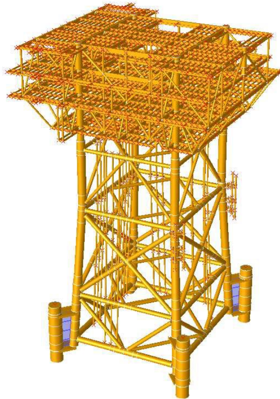
图 2.1-8 500MW 海上升压站结构示意图
