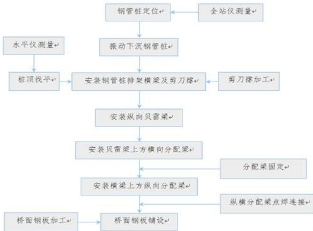
图 2.3.1-1 施工栈桥施工工艺流程图
