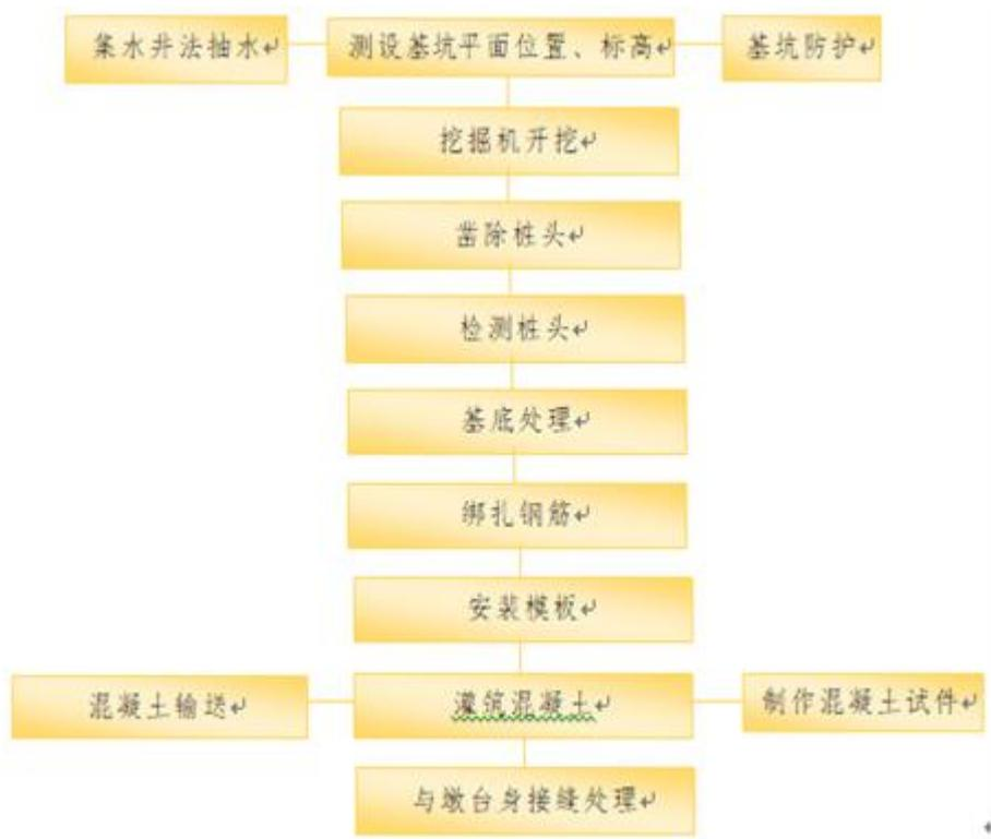
图 2.3.1-4 承台、系梁施工工艺框图
