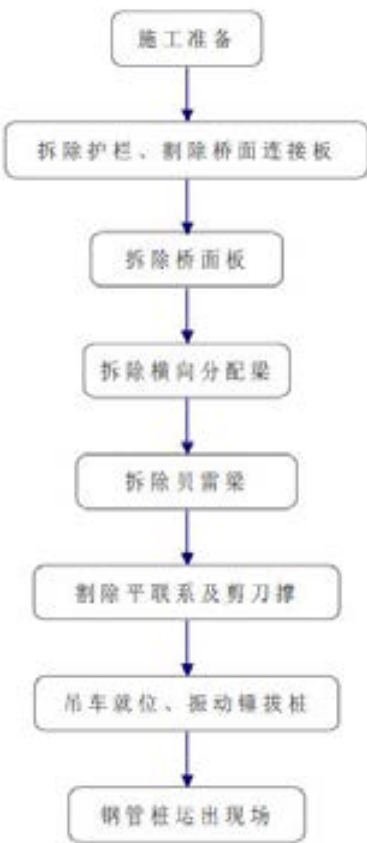
图 3.3-11 施工平台拆除工艺流程图
