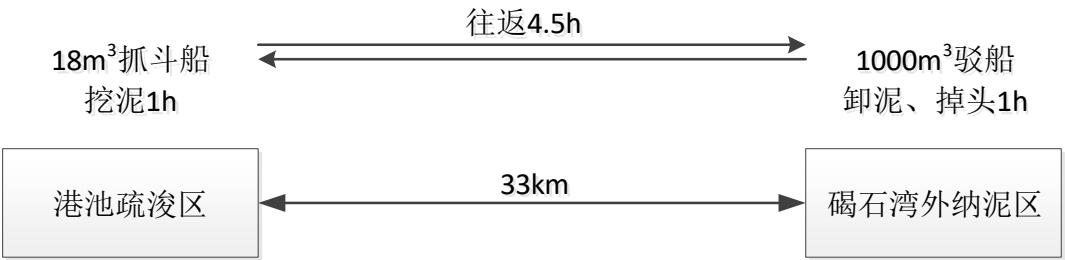
图 3.3-8 本项目港池疏浚投入的抓斗船挖泥运转周期示意图
