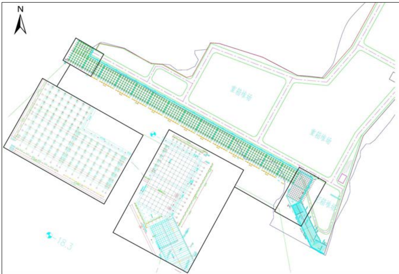
图 3.1-16 本项目码头桩基平面图
