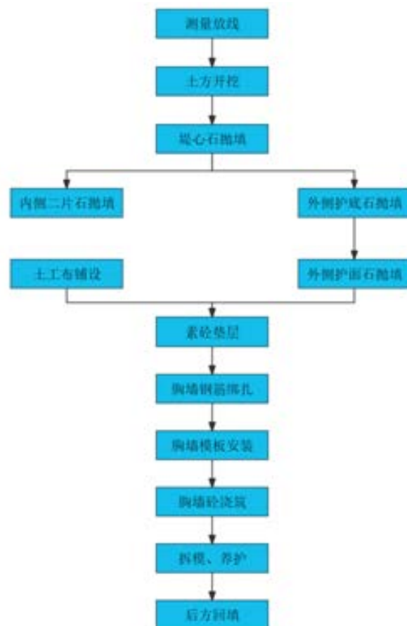
图 3.3-12 护岸施工工艺流程图
