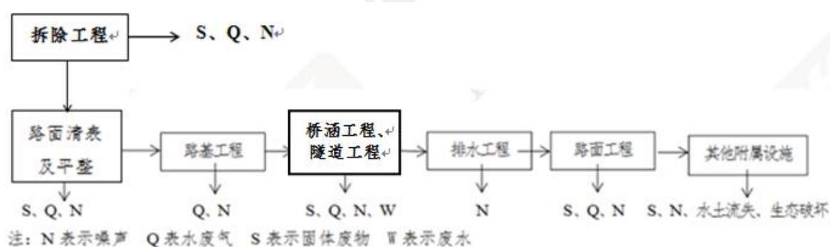
图 5-1 施工期工艺流程及产污环节图
