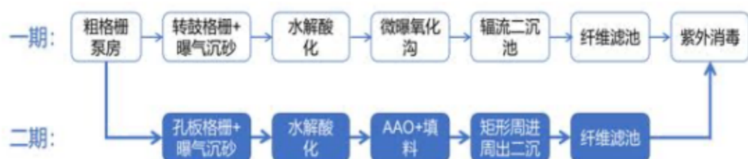
图 4-2 汕尾高新区红草园区综合污水处理厂工艺流程图
