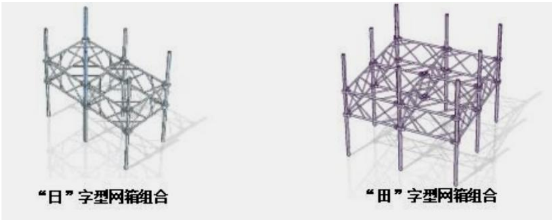
图 1.5.1-4 不同组合模块化拼装网箱
