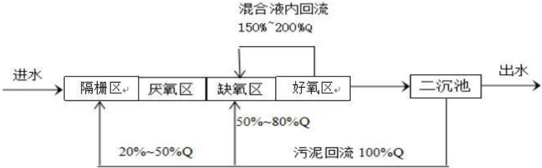
图 4-1 陆丰市海工基地污水处理厂工艺流程图
