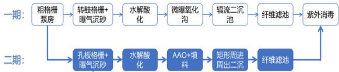
图6.1-2汕尾高新区红草园区综合污水处理厂工艺流程图
