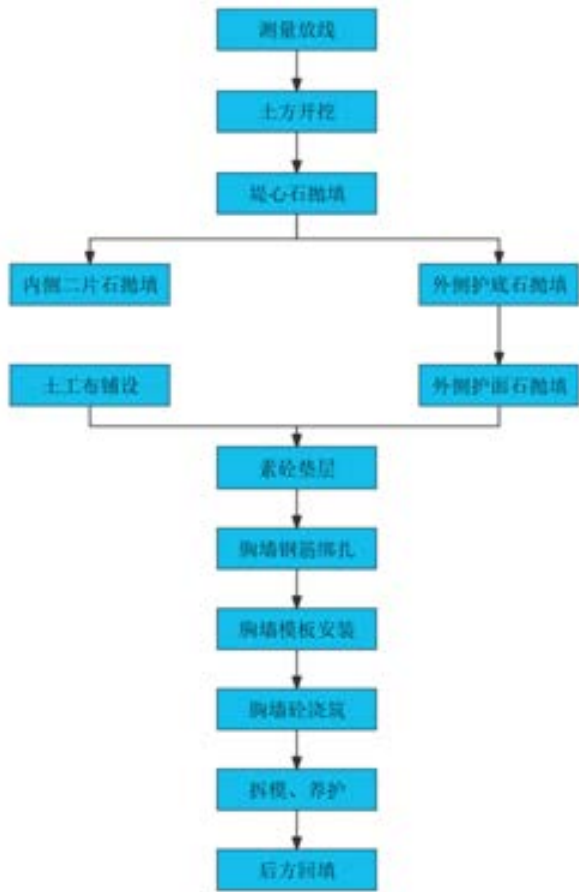
图 3.3-13 护岸施工工艺流程图
