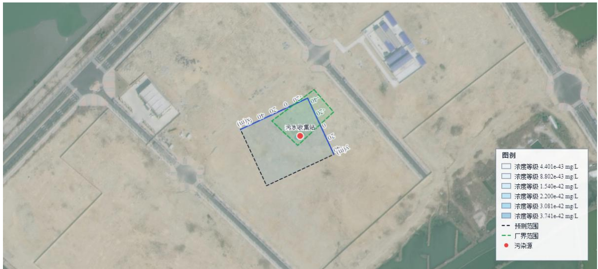
图 6.5.3-1 污水收集站-氰化物 t=100\text{ d} 浓度等值线图
