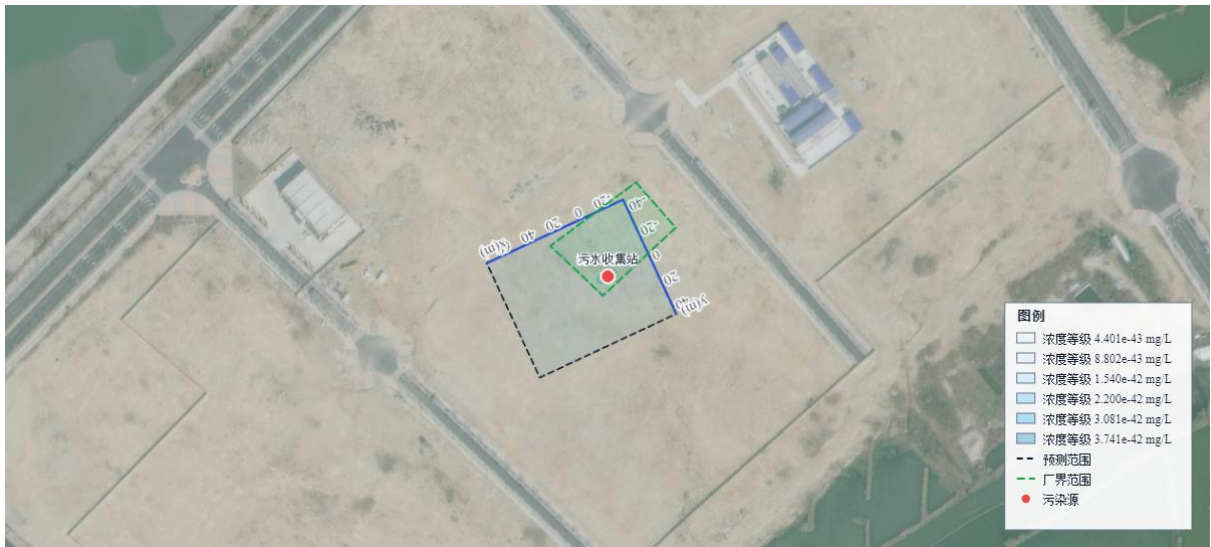
图 6.5.3-1 污水收集站-耗氧量（CODMn 法，以 O 2 计） t=100 d 浓度等值线图
