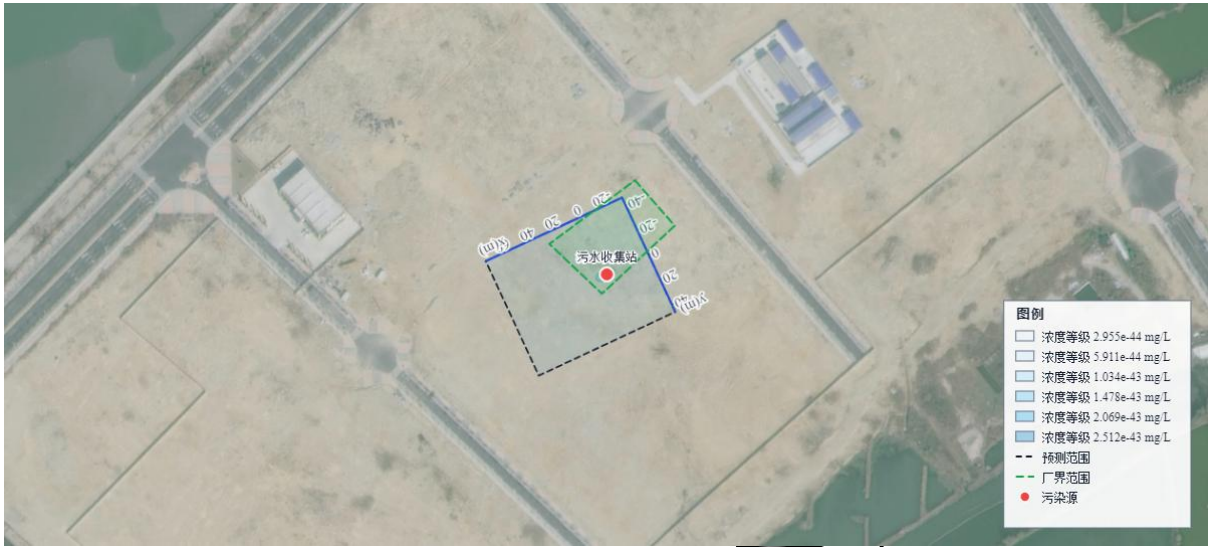
图 6.5.3-11 污水收集站-镍 t=100 d 浓度等值线图
