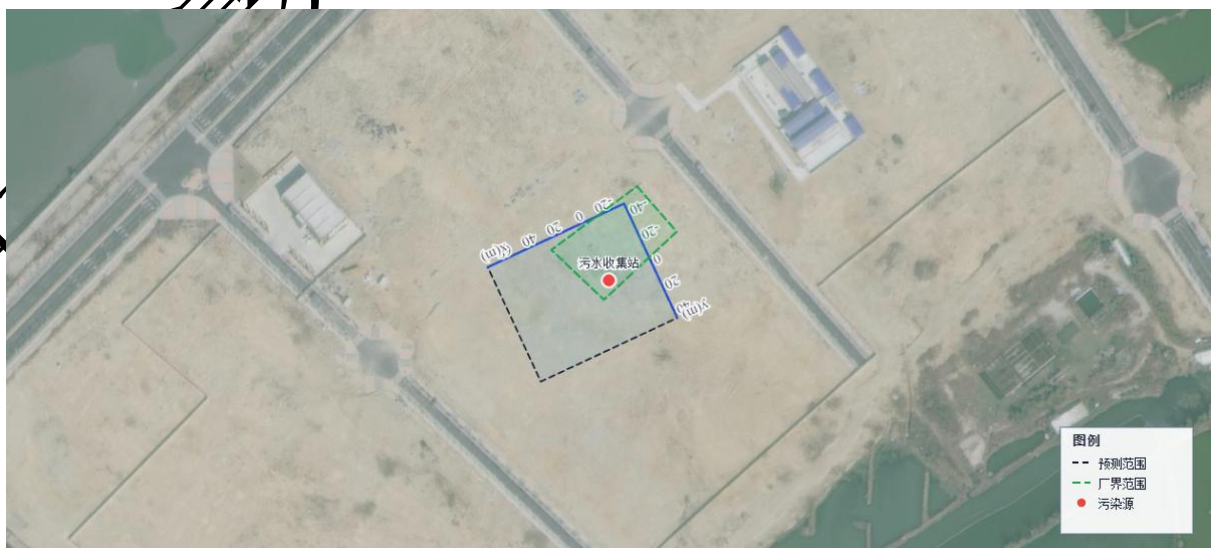
图 6.5.3-3 污水收集站-氰化物 t=1000\text{ d} 浓度等值线图
