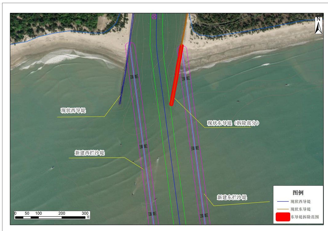
图 2.7.3-5 现状东导堤拆除范围示意图
