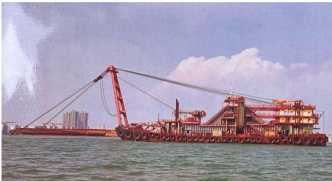
图 2.7.3-6 冲吸式挖泥船示意图
