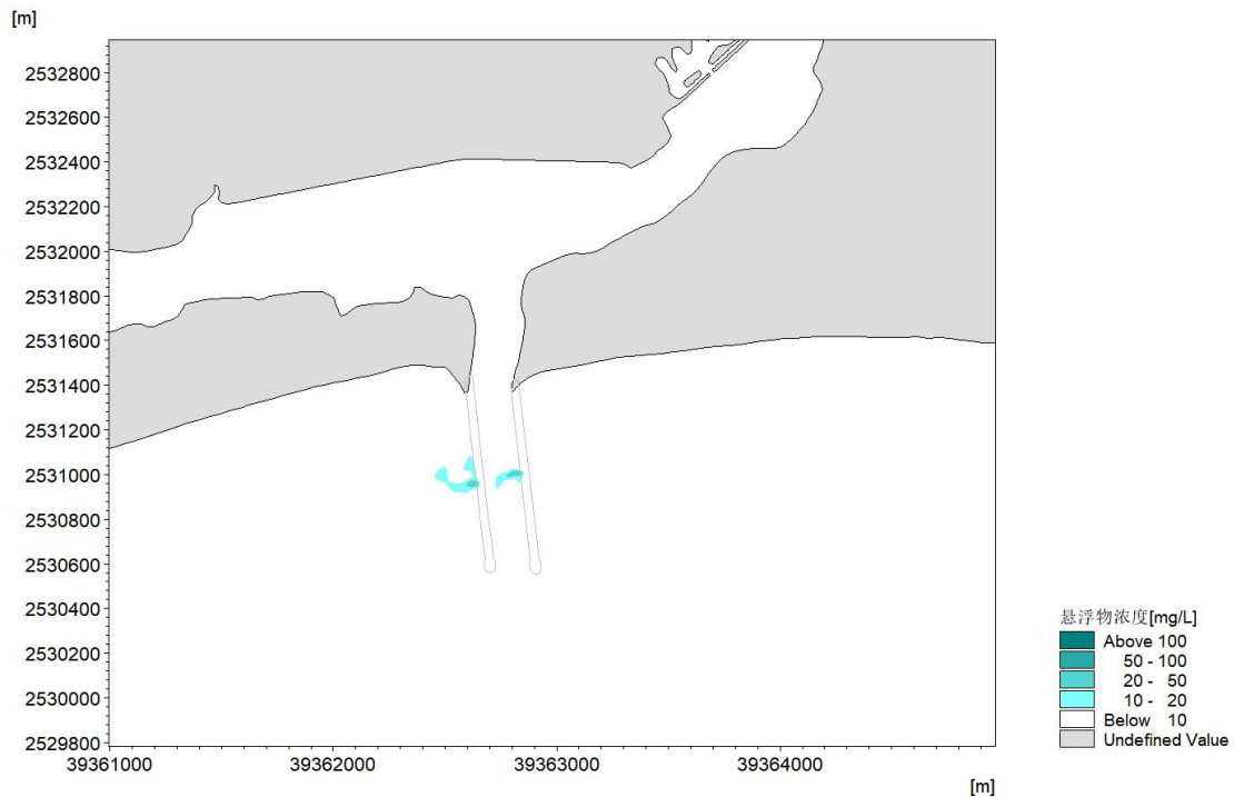
图 6.3.3-4b 东、西防波堤（典型工况）施工悬浮物影响范围
