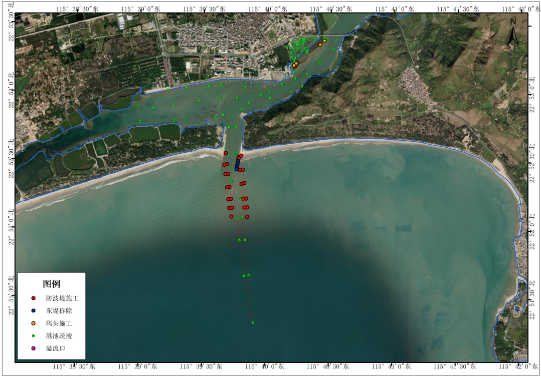
图 6.3.3-1a 施工悬浮泥沙源强点设置
