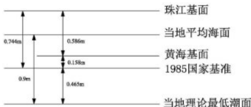
图 4.1.2-1 汕尾海洋站基面高程关系示意图
