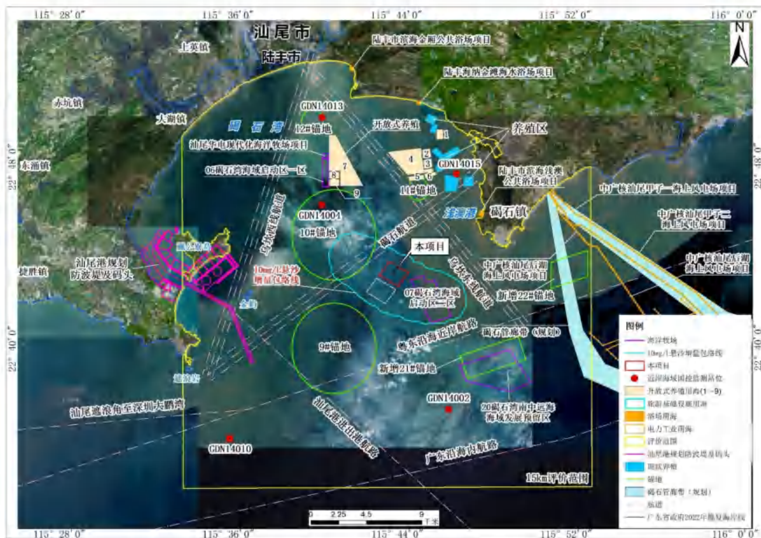
图 6.10-1a 两个采砂区同时开采最大包络线工况悬浮泥沙增量 >10\text{mg/L} 包络线与社会活动关注区叠图（夏季水文条件下）
