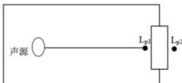
图 5.2-4 室内声源等效为室外声源图例
