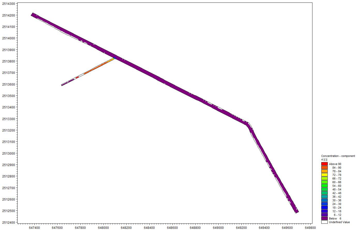
图 5.2-18 枯水期非正常工况 BOD 包络线图
