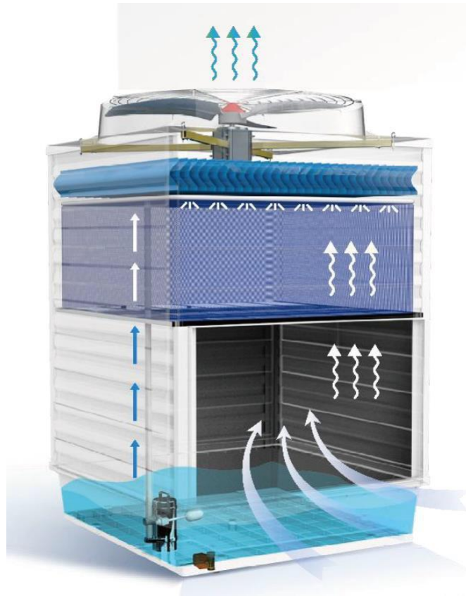
图 6.2-3 生物喷淋除臭装置原理图
