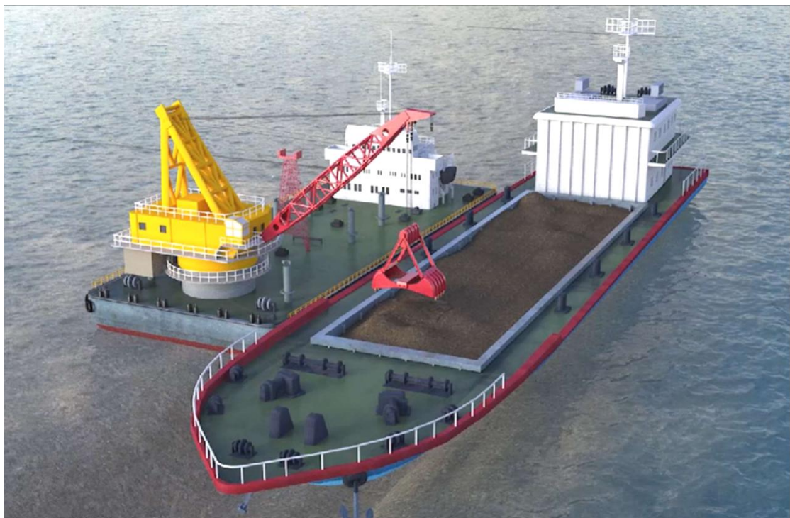
图 2.4-2 抓斗挖泥船施工三维示意图
