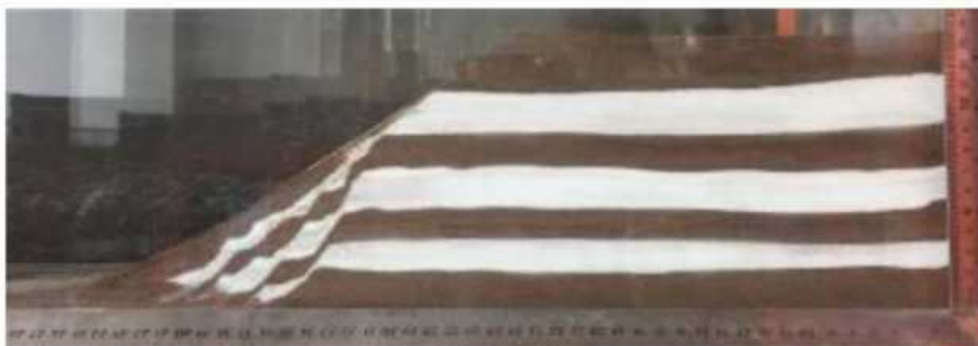
图 6.3.5-2c 采砂深度 14cm 实验照片
