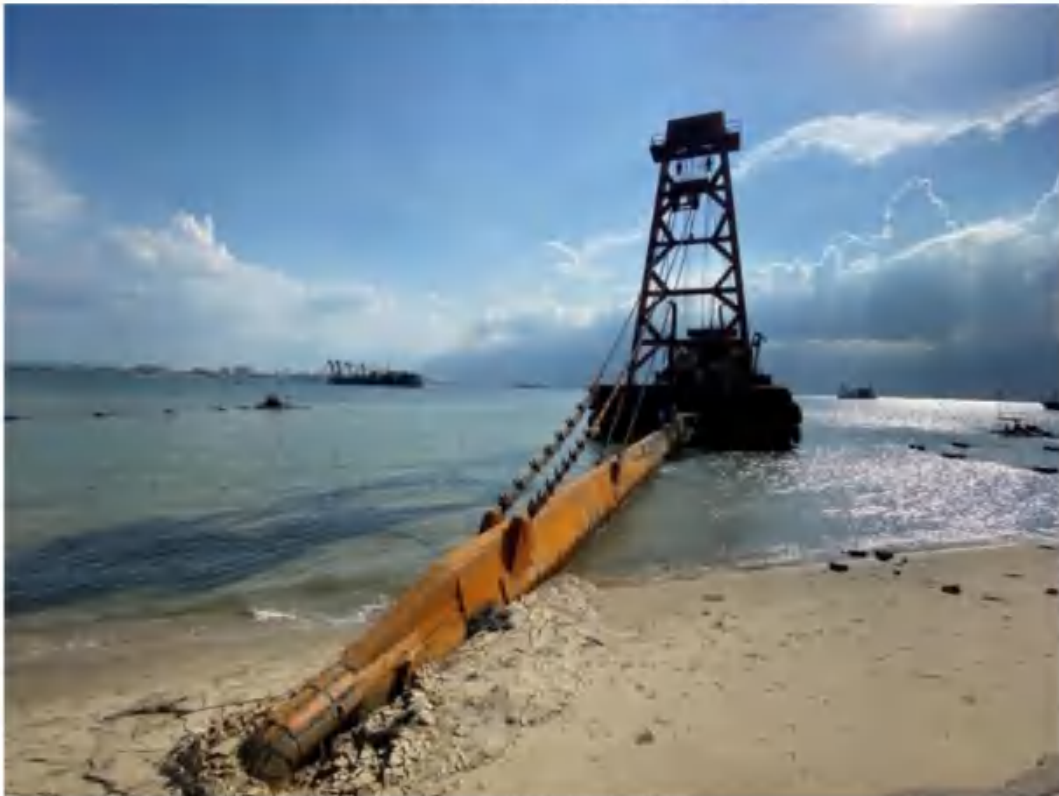
图 3.4-2 射流式采砂船
