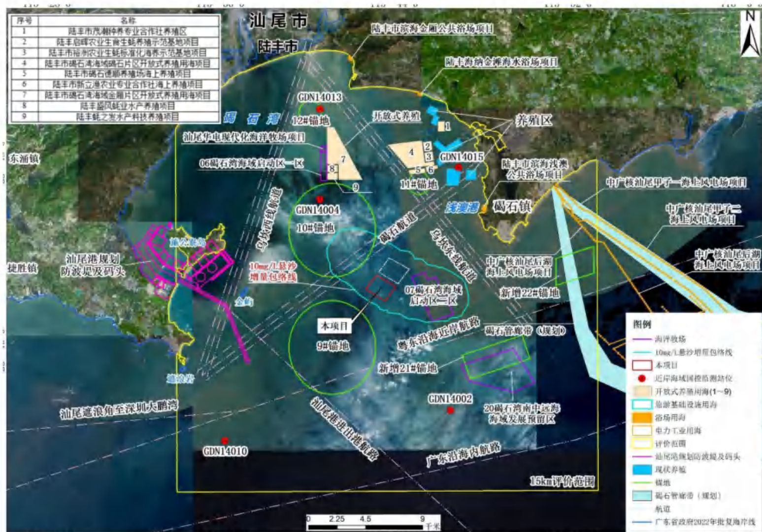
图 6.10-1a 两个采砂区同时开采最大包络线工况悬浮泥沙增量>10mg/L 包络线与社会活动关注区叠图(夏季水文条件下)
