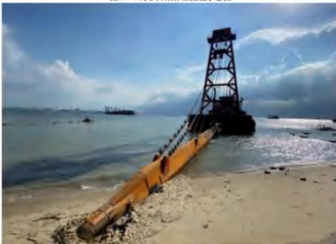
图 3.4-2 射流式采砂船
