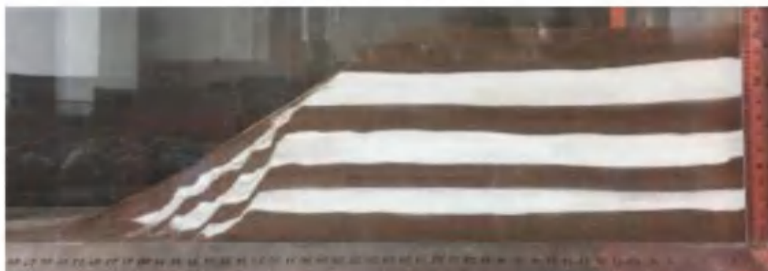
图 6.3.5-2c 采砂深度 14cm 实验照片
