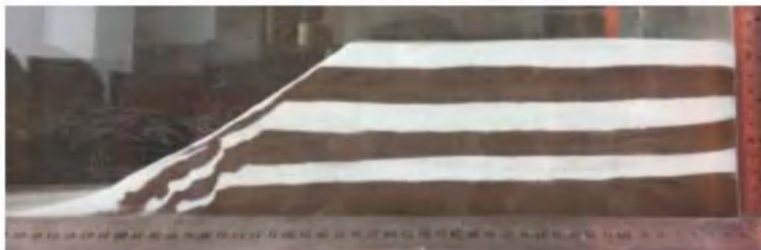
图 6.3.5-2b 采砂深度 11cm 实验照片
