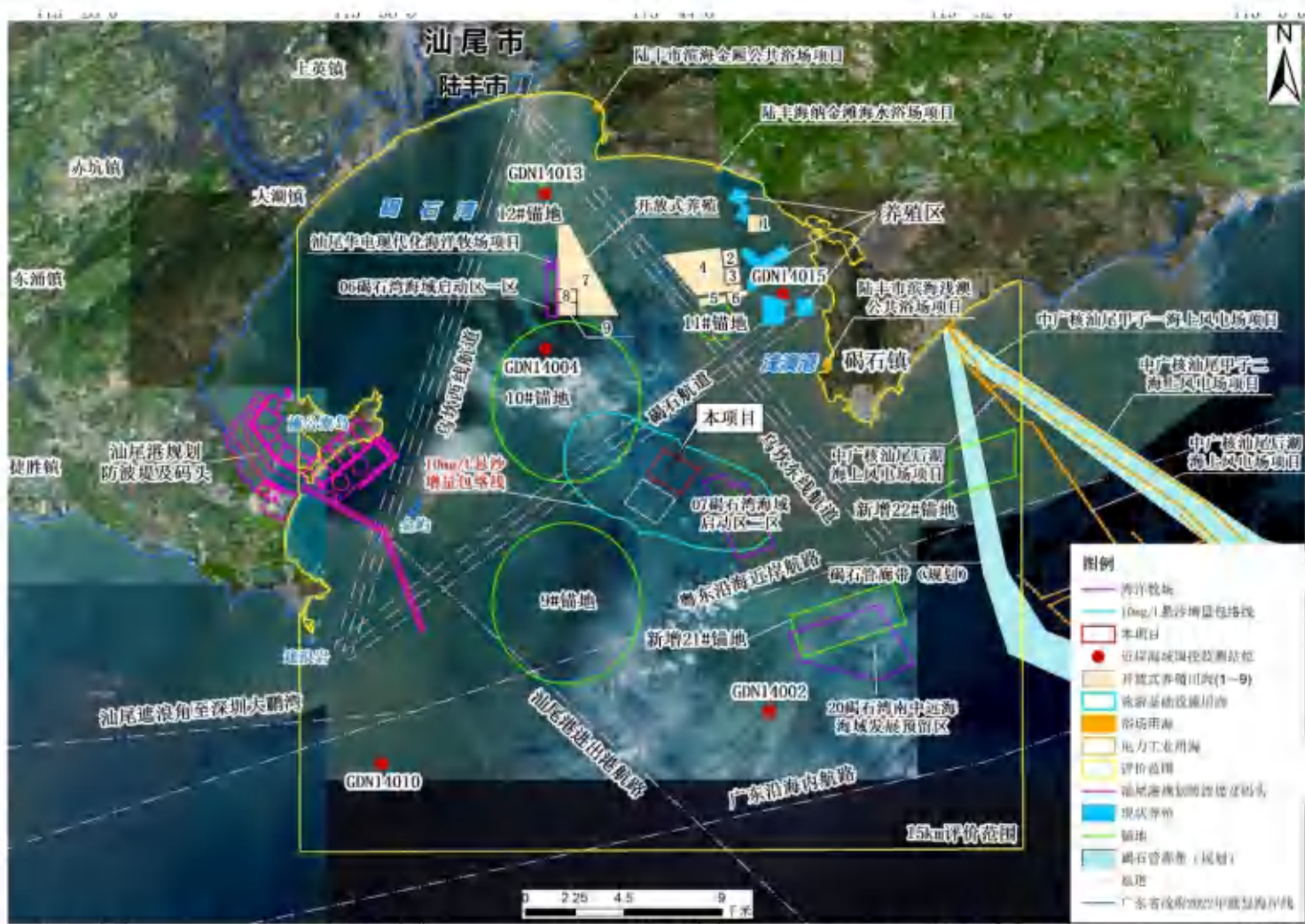
图 6.10-1b 两个采砂区同时开采最大包络线工况悬浮泥沙增量 >10\text{mg/L} 包络线与社会活动关注区叠图（冬季水文条件下）
