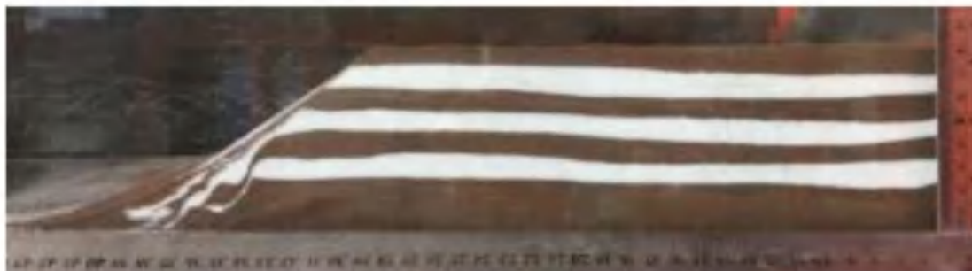
图 6.3.5-2a 采砂深度 8cm 实验照片
