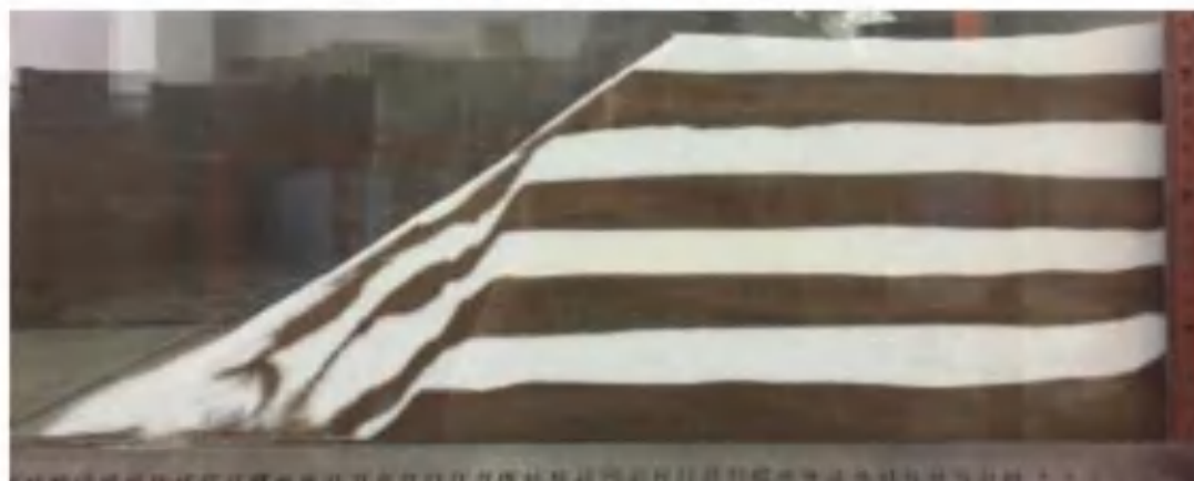
图 6.3.5-2d 采砂深度 17cm 实验照片
