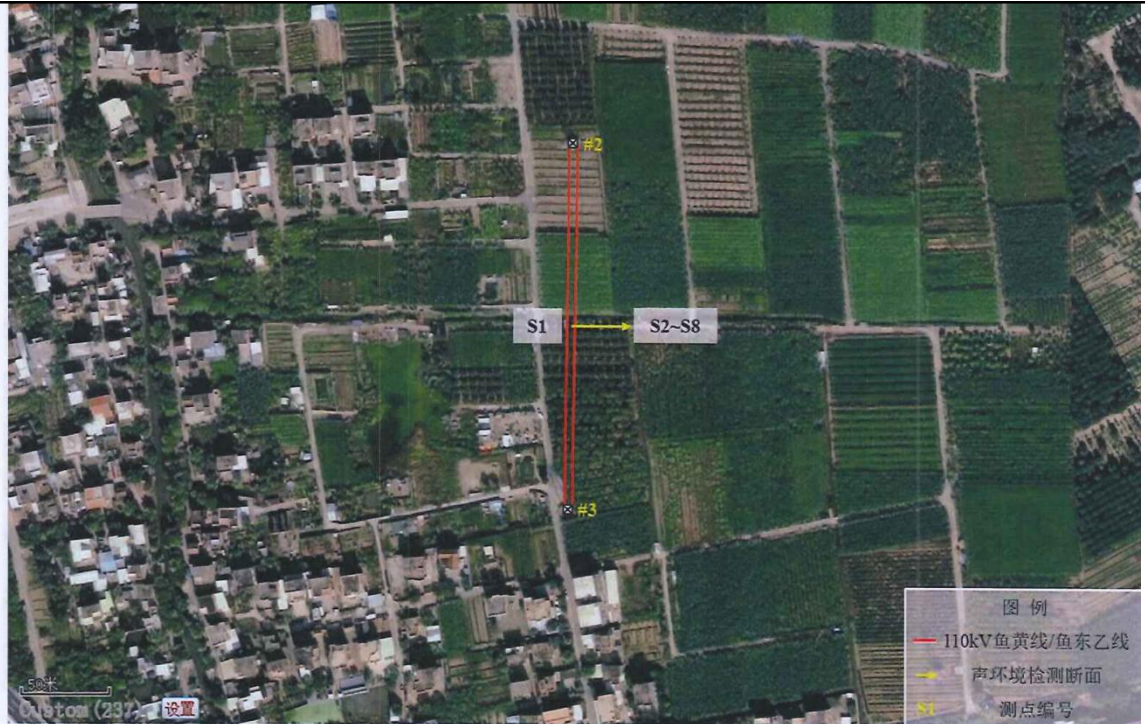
图 4-3 110kV 鱼黄线/鱼东乙线监测布点图
