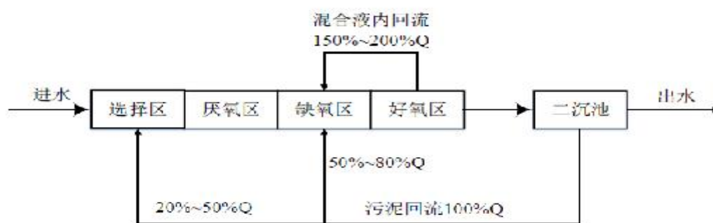
图 4.2-2 汕尾高新区红草园区综合污水处理厂工艺流程图
