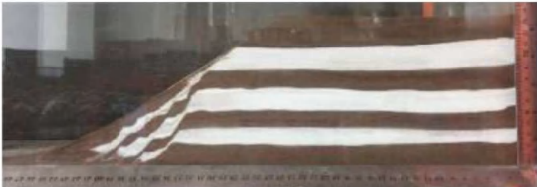
图 6.3.5-2c 采砂深度 14cm 实验照片
