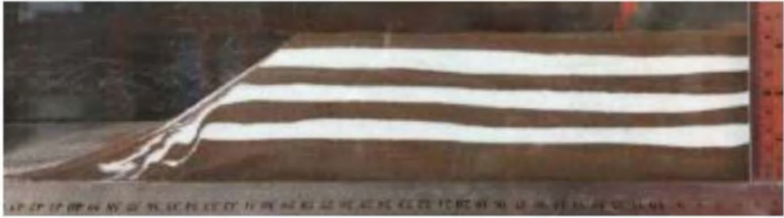
图 6.3.5-2a 采砂深度 8cm 实验照片
