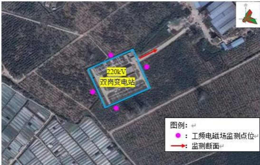
图 1 东莞 220 千伏双岗变电站监测布点图
