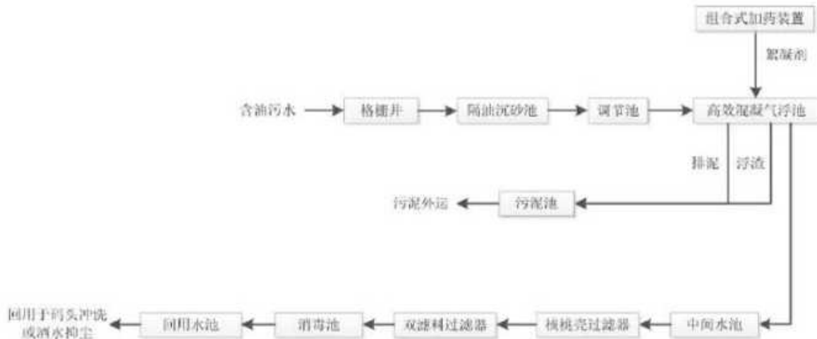
图 9.2.1-3 含油污水处理工艺流程图
