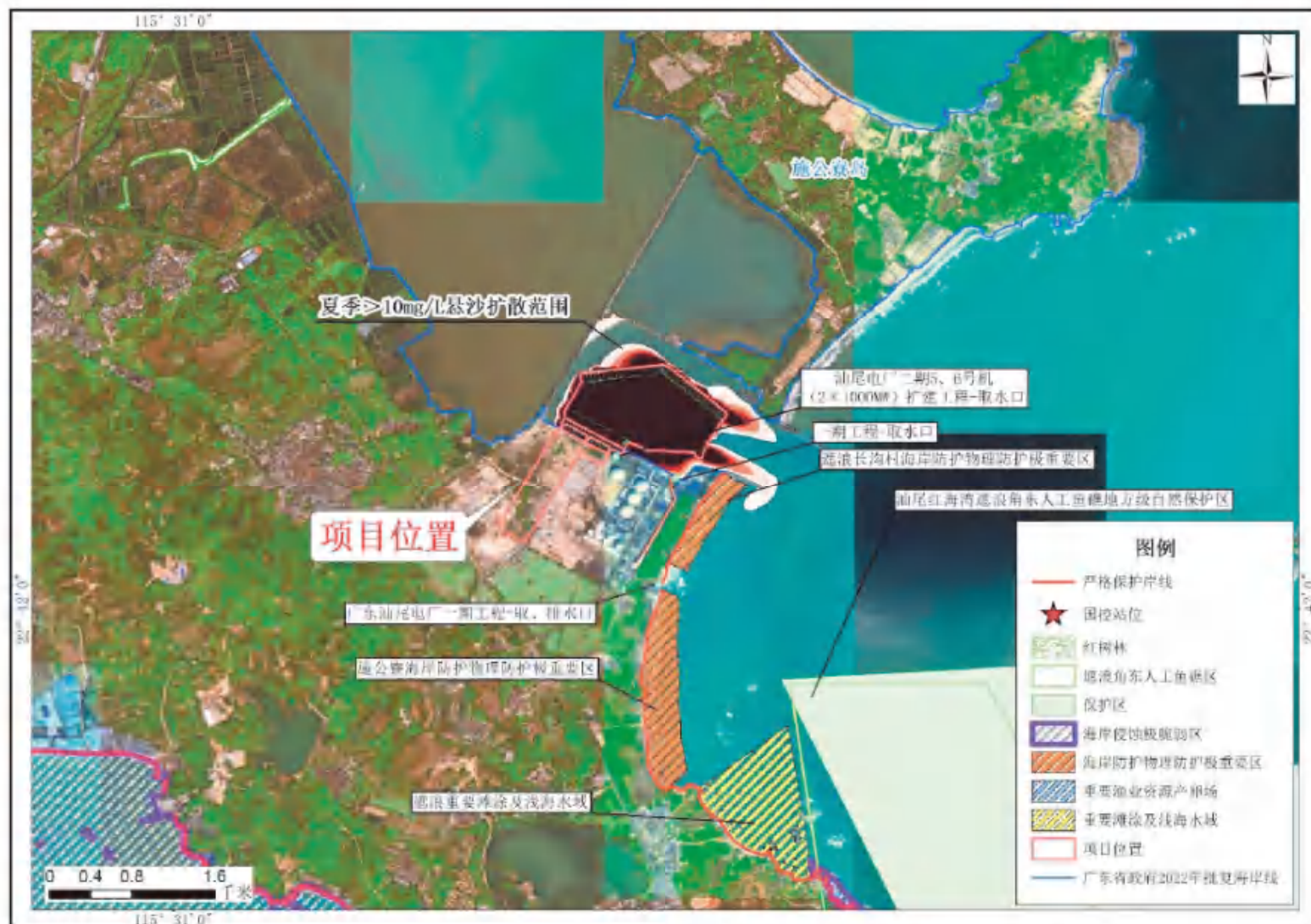
图 7.8.3-1b 施工悬浮物扩散大于 10mg/L 最大包络线与海洋环境敏感区叠图（夏季）
