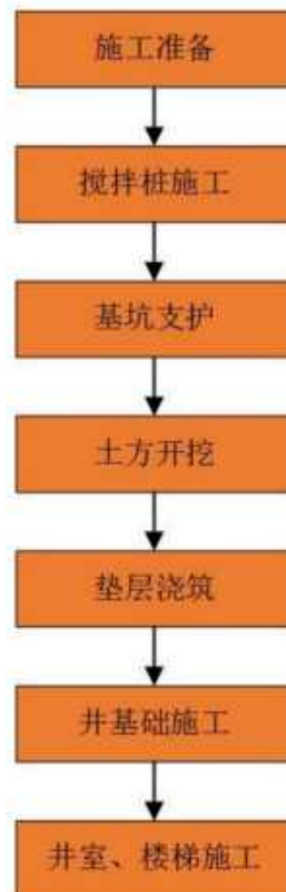
图 3.5.5-1 高位井施工流程图
