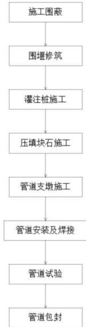
图 3.5.2-1 架管段施工工艺图
