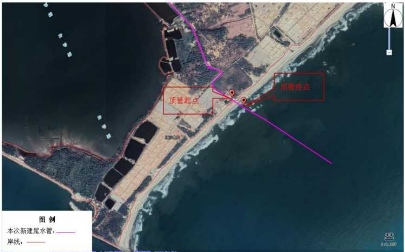
图 3.2.4-1 施工寮岛岸线顶管穿越岸线
