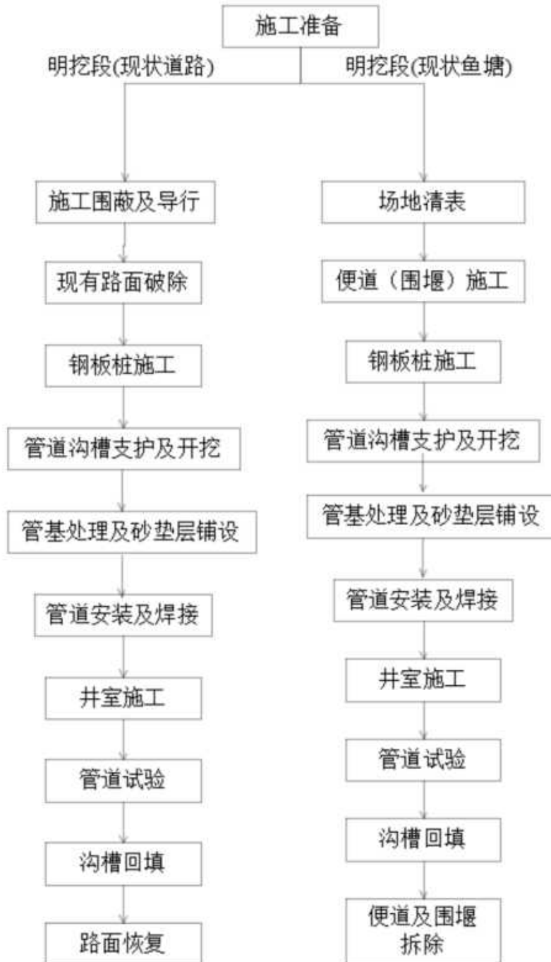
图 3.5.1-1 管道明挖段施工工艺图
