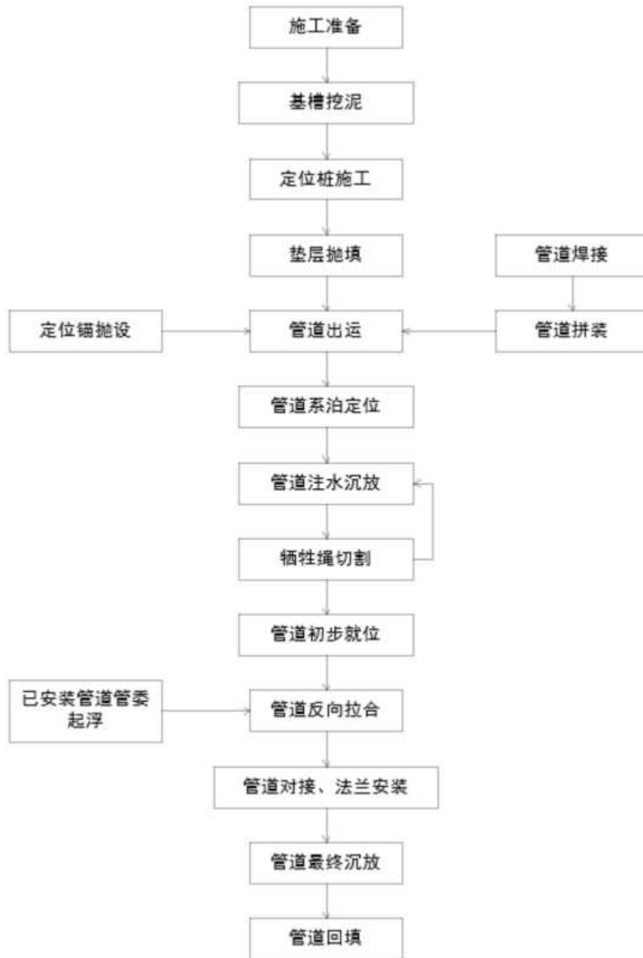
图 3.5.4-1 海域沉管段施工工艺
