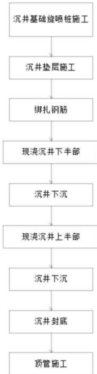
图 3.5.3-1 顶管段施工工艺流程图
