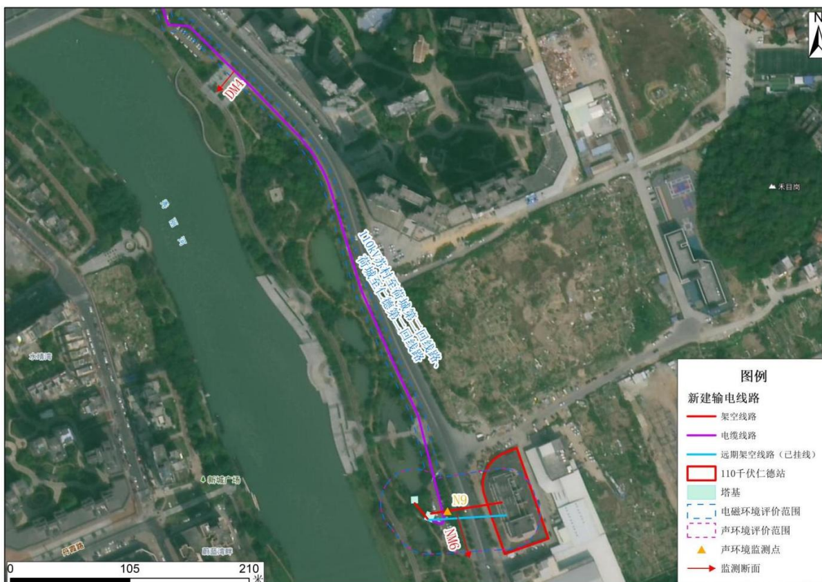
ZT1-图 8.3-1 110kV 荷苏乙线与 110kV 荷仁乙线双回线路类比监测布点图
