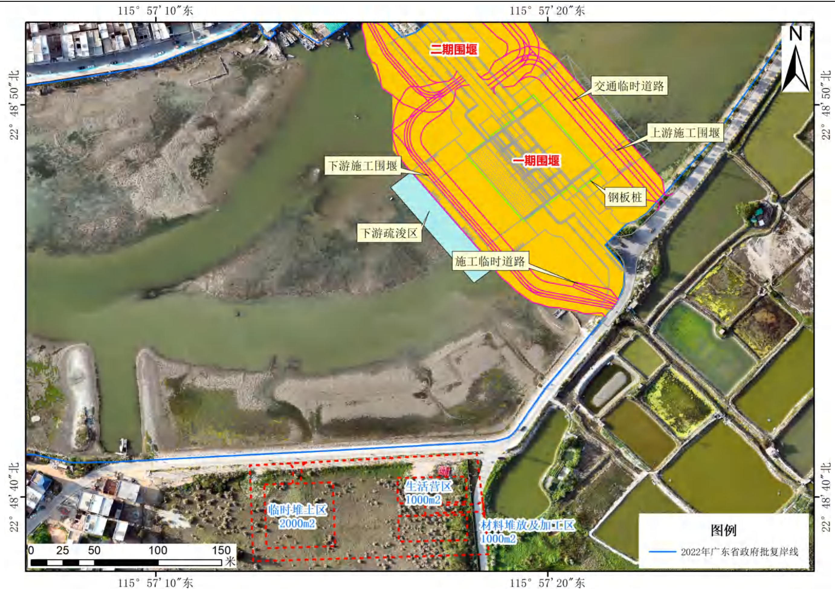
图 3.2.2-4 施工临时工程总平面布置图与正射影像叠加图
