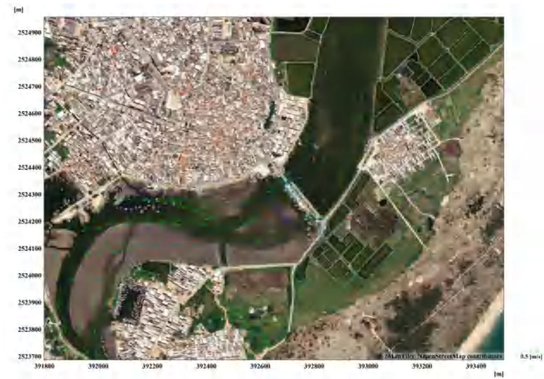
图 7.3.1-14 湖东海域附近海域落急流场图（开闸，P=5%洪峰流量 408.42m 3 /s）
