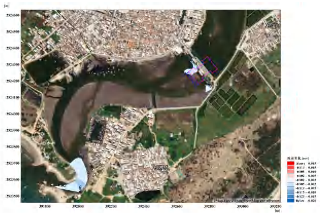
图 7.3.1-27 工程前、后落急时刻流速变化等值线图（闭闸）（工程后-工程前）
