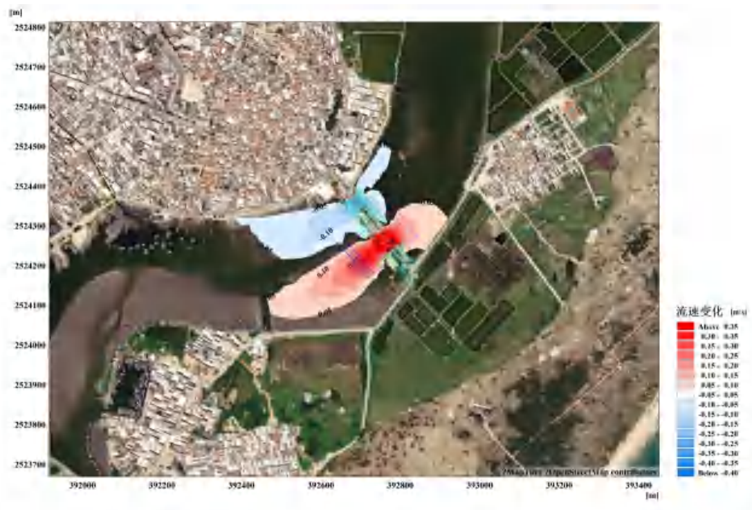
图 7.3.1-28 工程前、后涨急时刻流速变化等值线图（开闸，不泄洪）（工程后-工程前）
