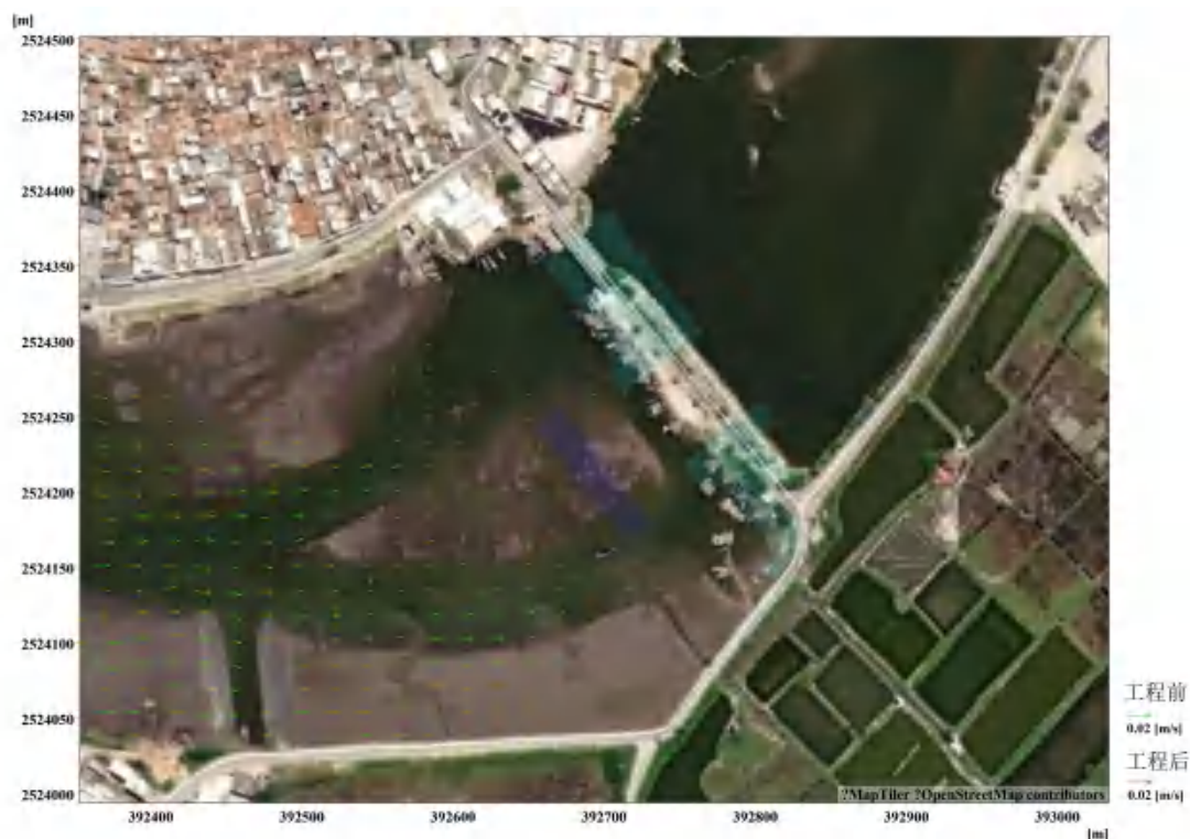
图 7.3.1-19 工程前、后涨急时刻桥闸附近的流场对比图（闭闸）
