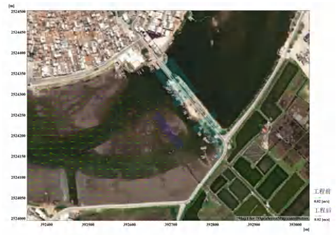
图 7.3.1-20 工程前、后落急时刻桥闸附近的流场对比图（闭闸）
