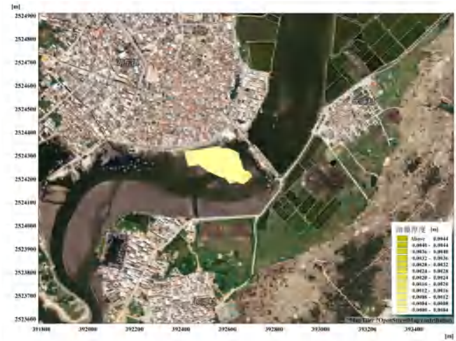
图 8.2.3-2 E 向 2.4 m/s 风速大潮涨急时刻燃油泄漏的油膜漂移扩散范围（72h）
