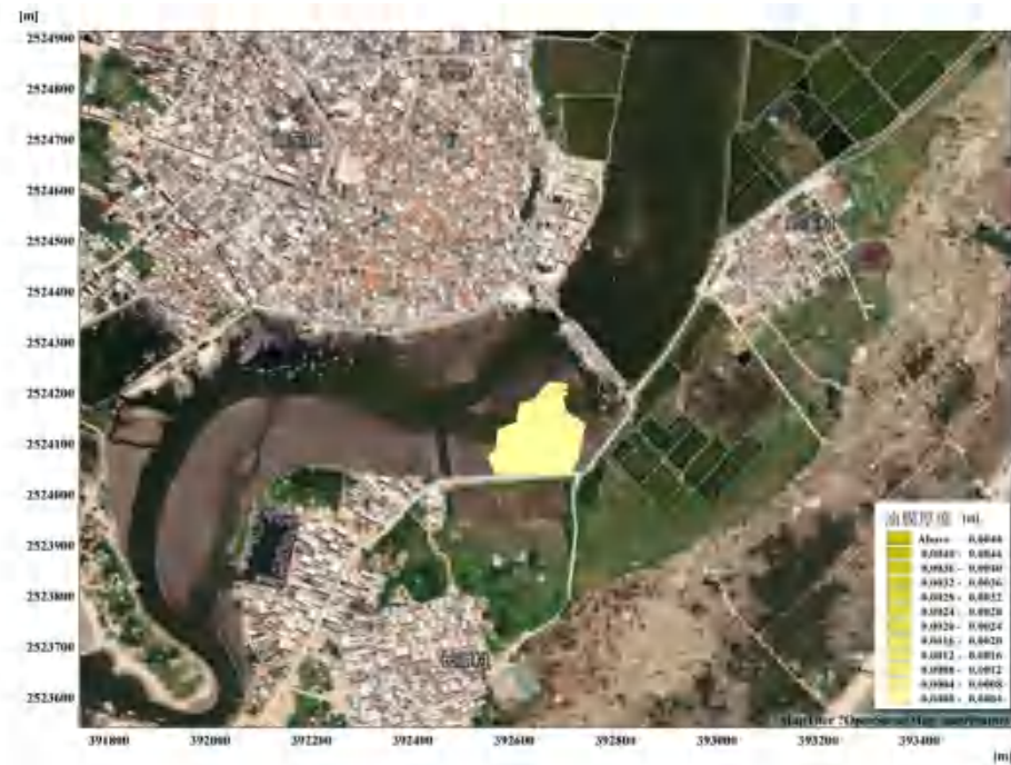
图 8.2.3-3 NNW 向 2.4m/s 风速大潮落急时刻燃油泄漏的油膜漂移扩散范围（72h）
