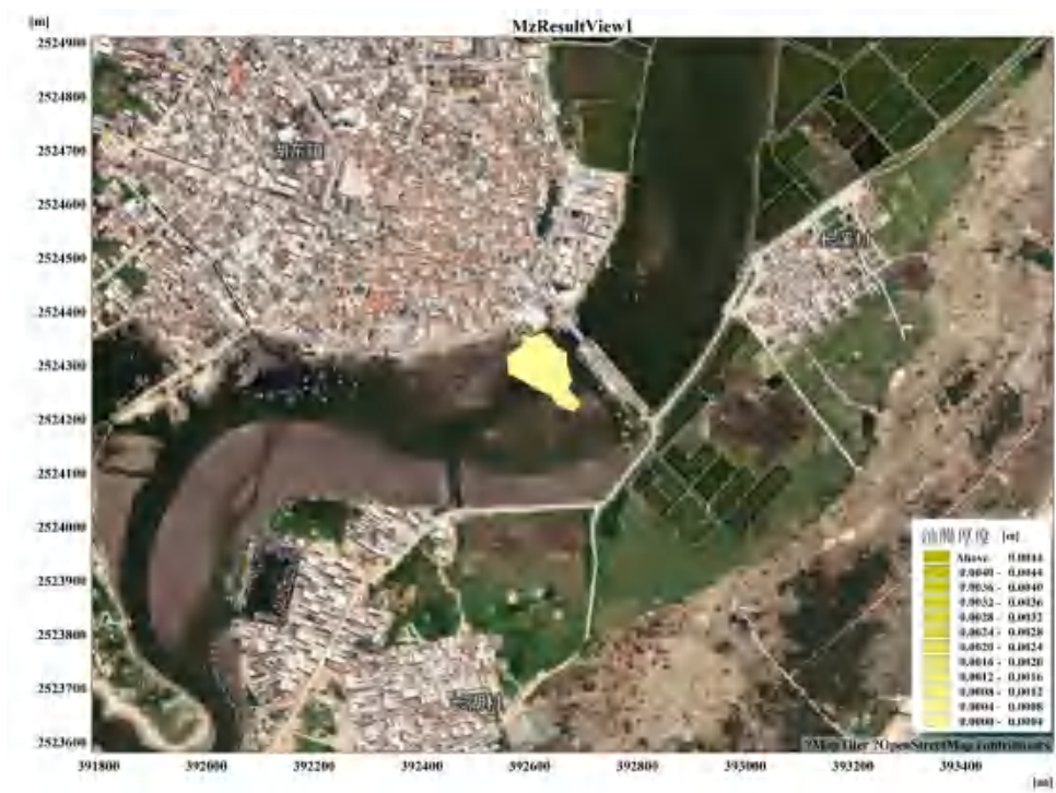
图 8.2.3-4 SE 向 13.8 m/s 风速大潮涨急时刻燃油泄漏的油膜漂移扩散范围（72h）
