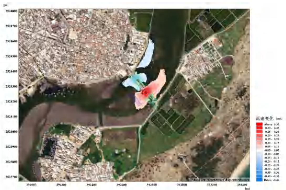
图 7.3.1-29 工程前、后落急时刻流速变化等值线图（开闸，不泄洪）（工程后-工程前）
