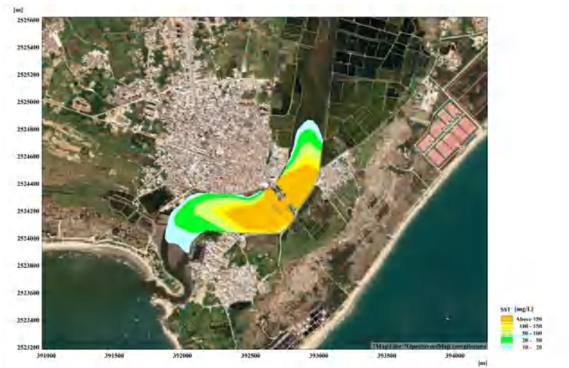
图 7.3.3-7 工况 2 施工悬浮物增量包络线
