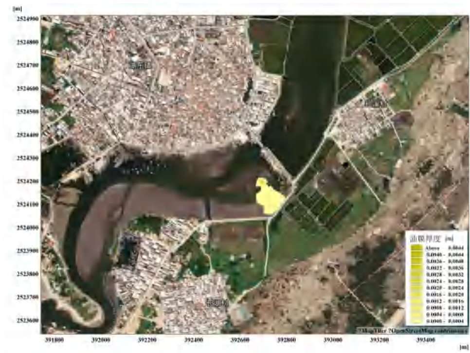
图 8.2.3-5 NW 向 13.5 m/s 风速大潮落急时刻燃油泄漏的油膜漂移扩散范围（72h）
