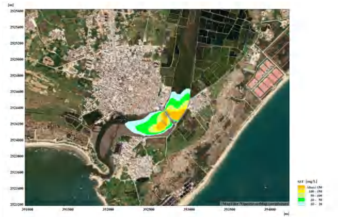
图 7.3.3-9 工况 4 施工悬浮物增量包络线
