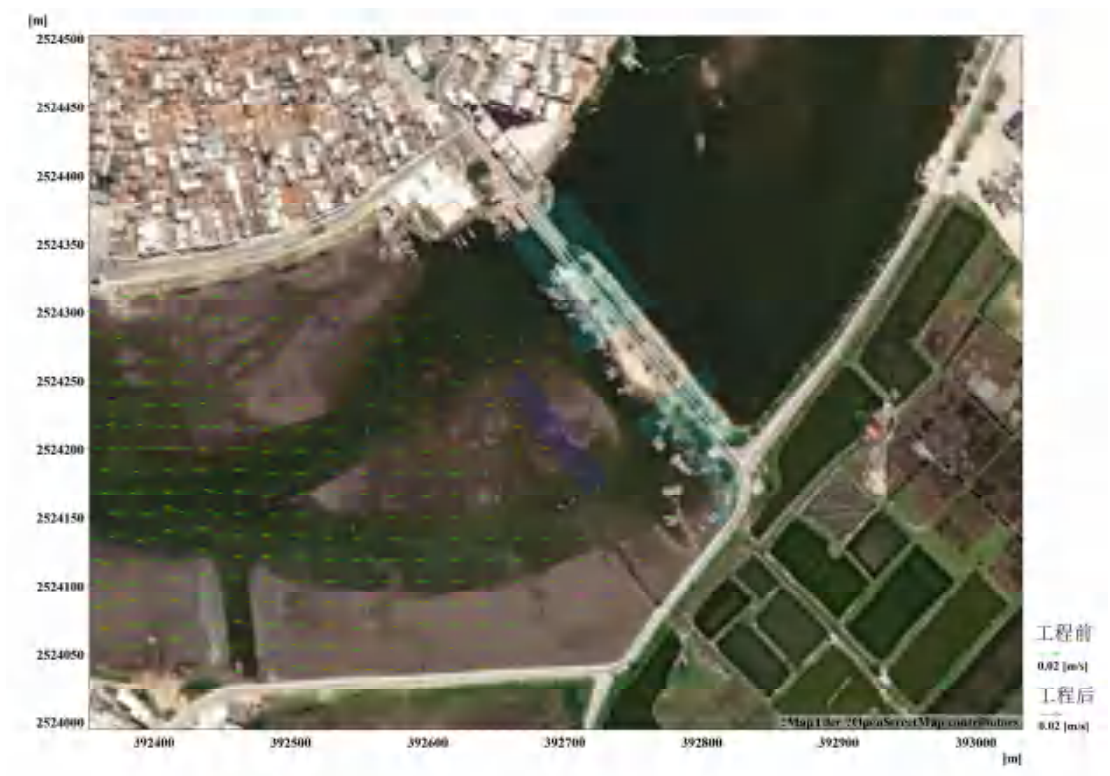
图 7.3.1-21 工程前、后涨急时刻桥闸附近的流场对比图（开闸，不泄洪）
