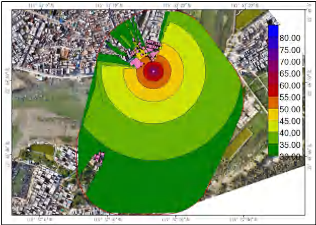
图 7.2.1-1 打桩机施工噪声贡献值等值线图
