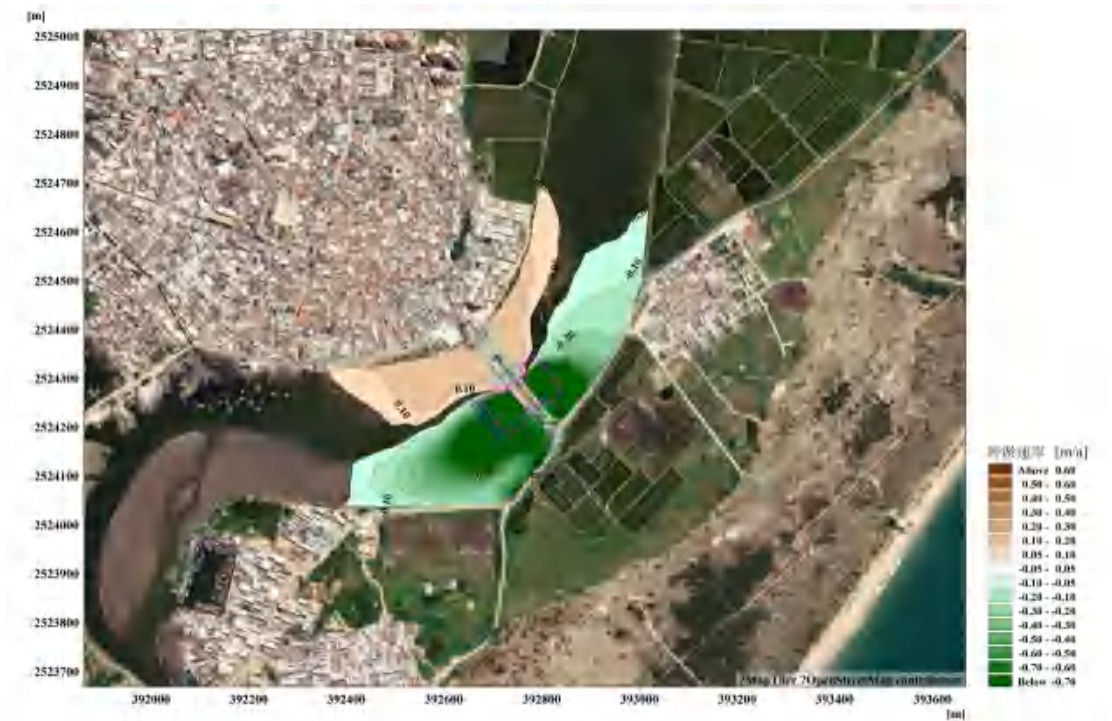
图 7.3.2-1 项目建设后附近河床冲淤态势图
