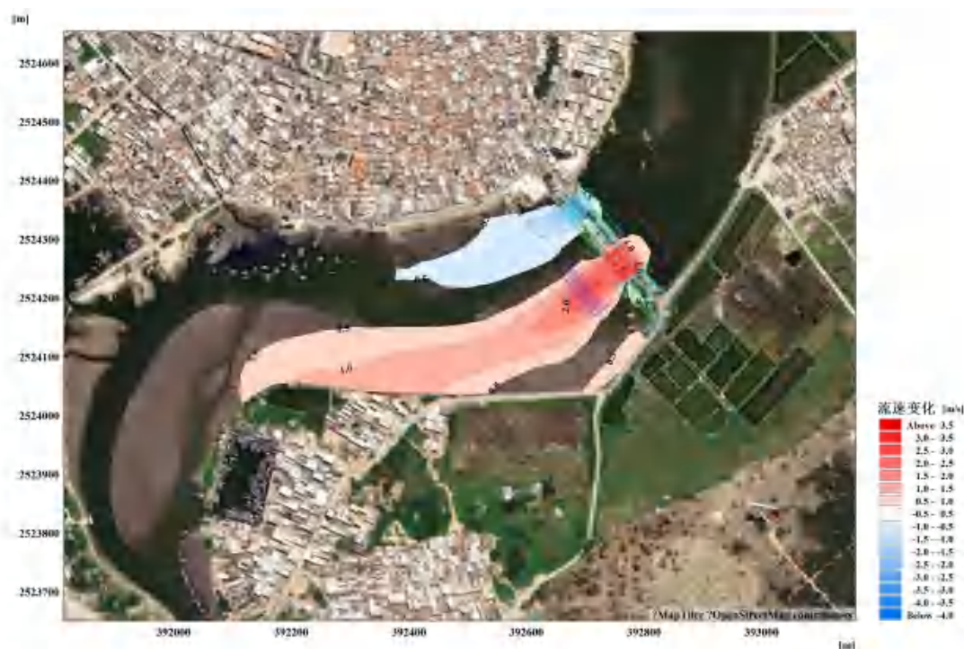
图 7.3.1-30 工程前、后落急时刻流速变化等值线图（开闸，P=5%洪峰流量 408.42m 3 /s）（工程后-工程前）
