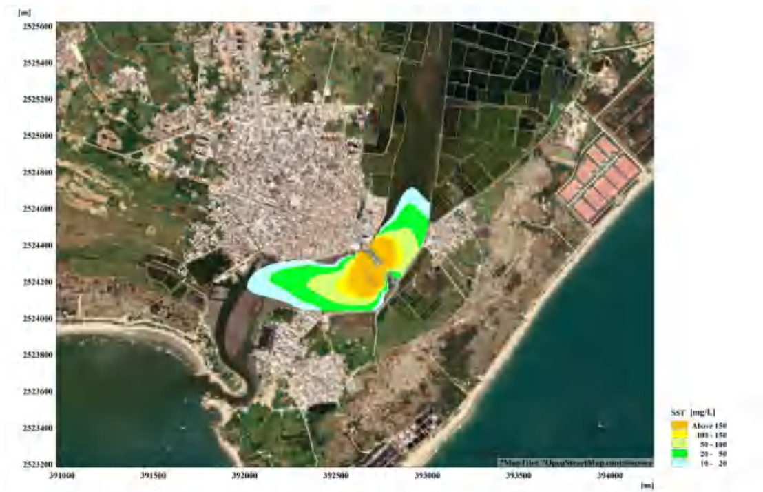
图 7.3.3-8 工况 3 施工悬浮物增量包络线
