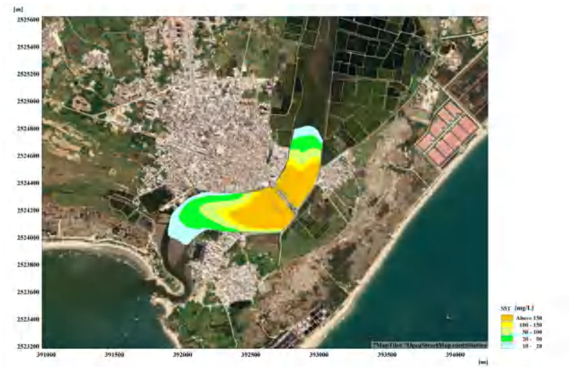
图 7.3.3-6 工况 1 施工悬浮物增量包络线
