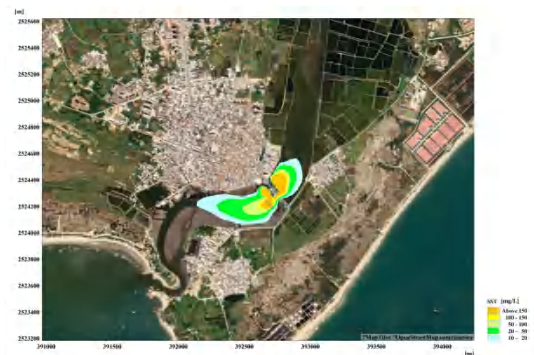
图 7.3.3-10 工况 5 施工悬浮物增量包络线
