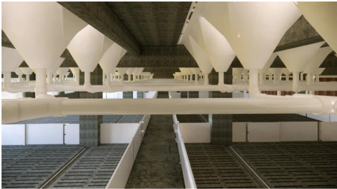
图 3.4-2 干清粪工艺猪舍下部结构视图
