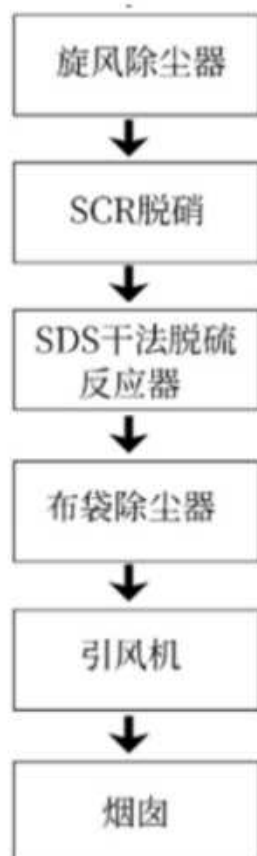
图 3.5.1-3 生物质导热油锅炉废气处理工艺流程图
