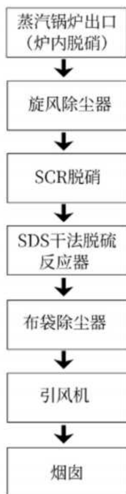
图 3.5.1-2 生物质蒸汽锅炉废气处理工艺流程图
