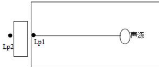
图 4-1 室内声源等效为室外声源图例
