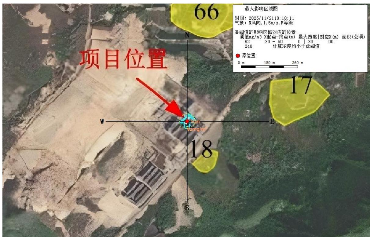
图 8.5.1-1 硝酸泄漏产生的硝酸最大影响区域图
