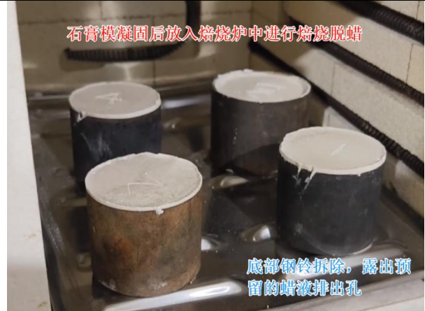
拆外壳后的石膏模放入焙烧炉 (相关案例图示，供参考)
