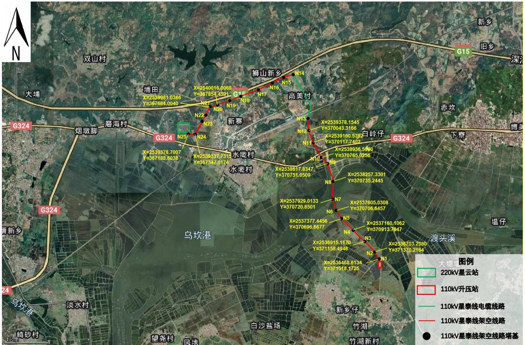
图 4 本工程线路拐点坐标示意图
