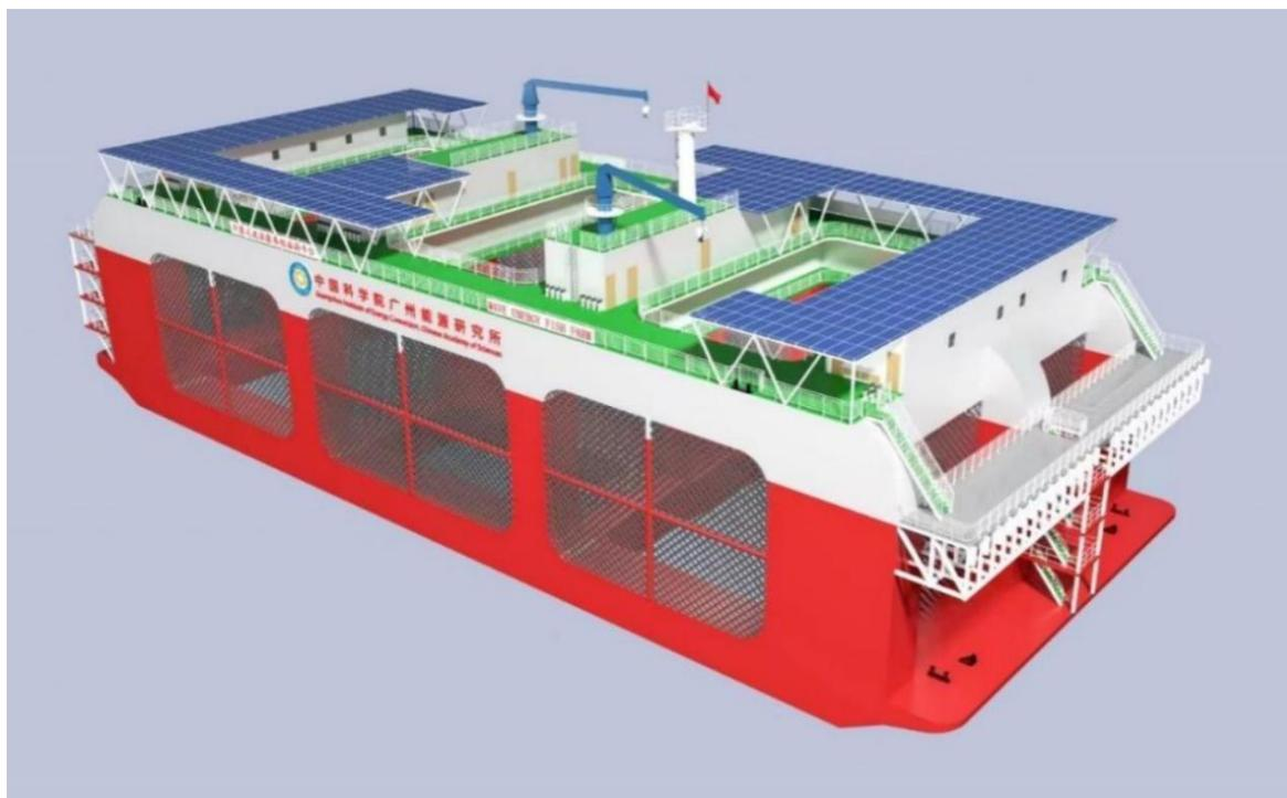
图 3.3-6 半潜式网箱示意图
