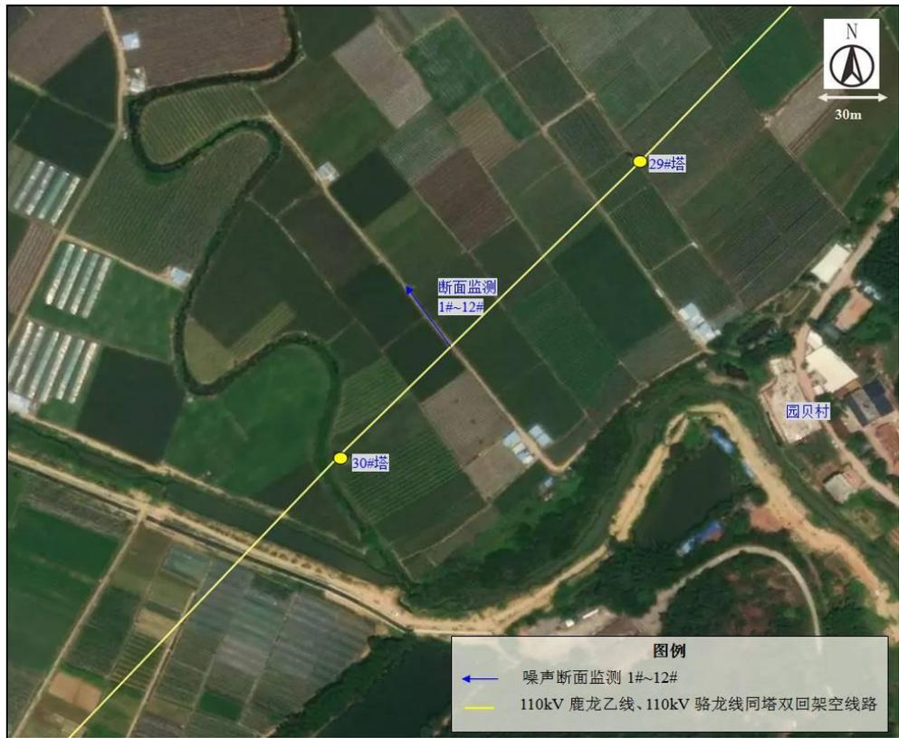
图 4-3 双回架空线路噪声类比监测布点图
