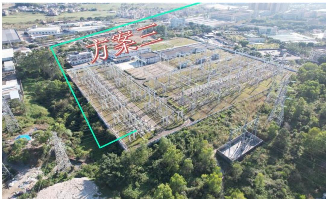
图 2-15 方案三路径与现状 110kV、220kV 架空线路交叉跨越情况
