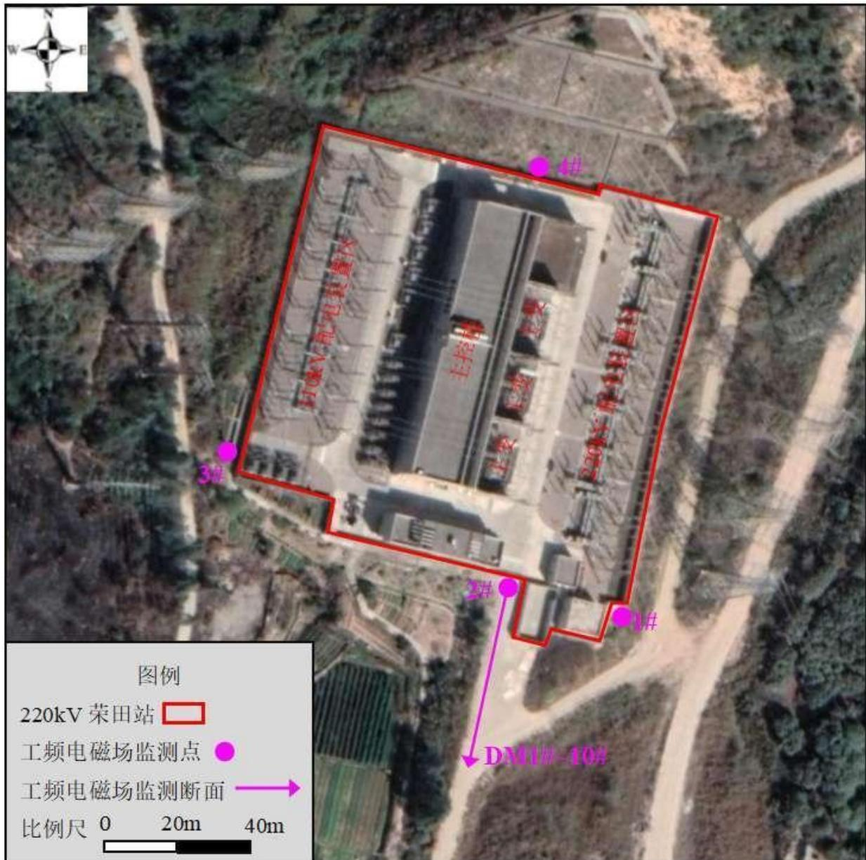
ZT1-图 8.1-8 惠州 220kV 荣田变电站监测布点图
