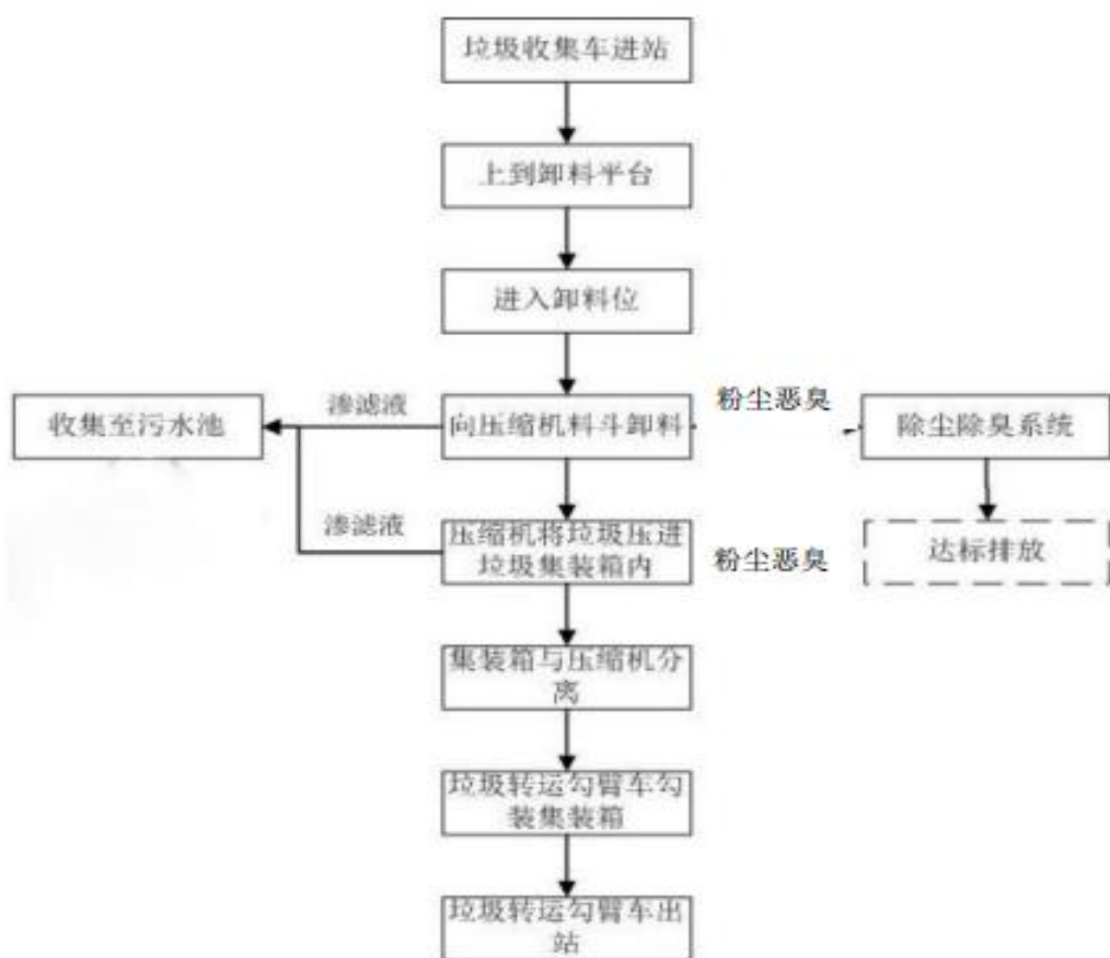
图 3.1-6 压缩二次转运站生产工艺流程图
