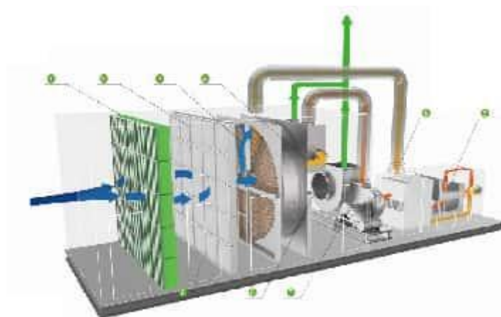
图 4-3 注液、化成、烘烤和电芯拆解废气处理流程图
