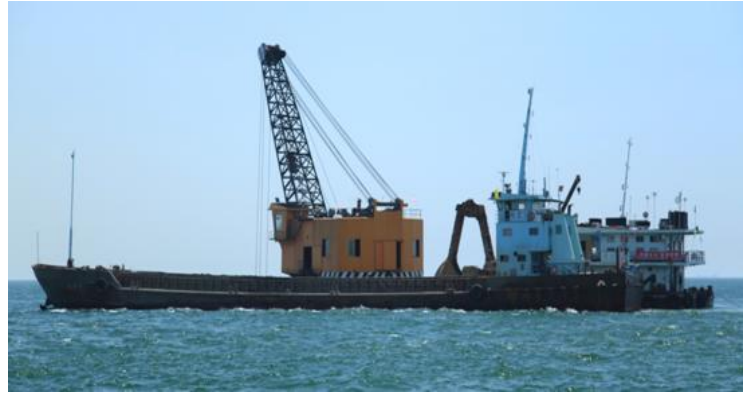
图 2.3-4 抓斗船挖泥施工图
