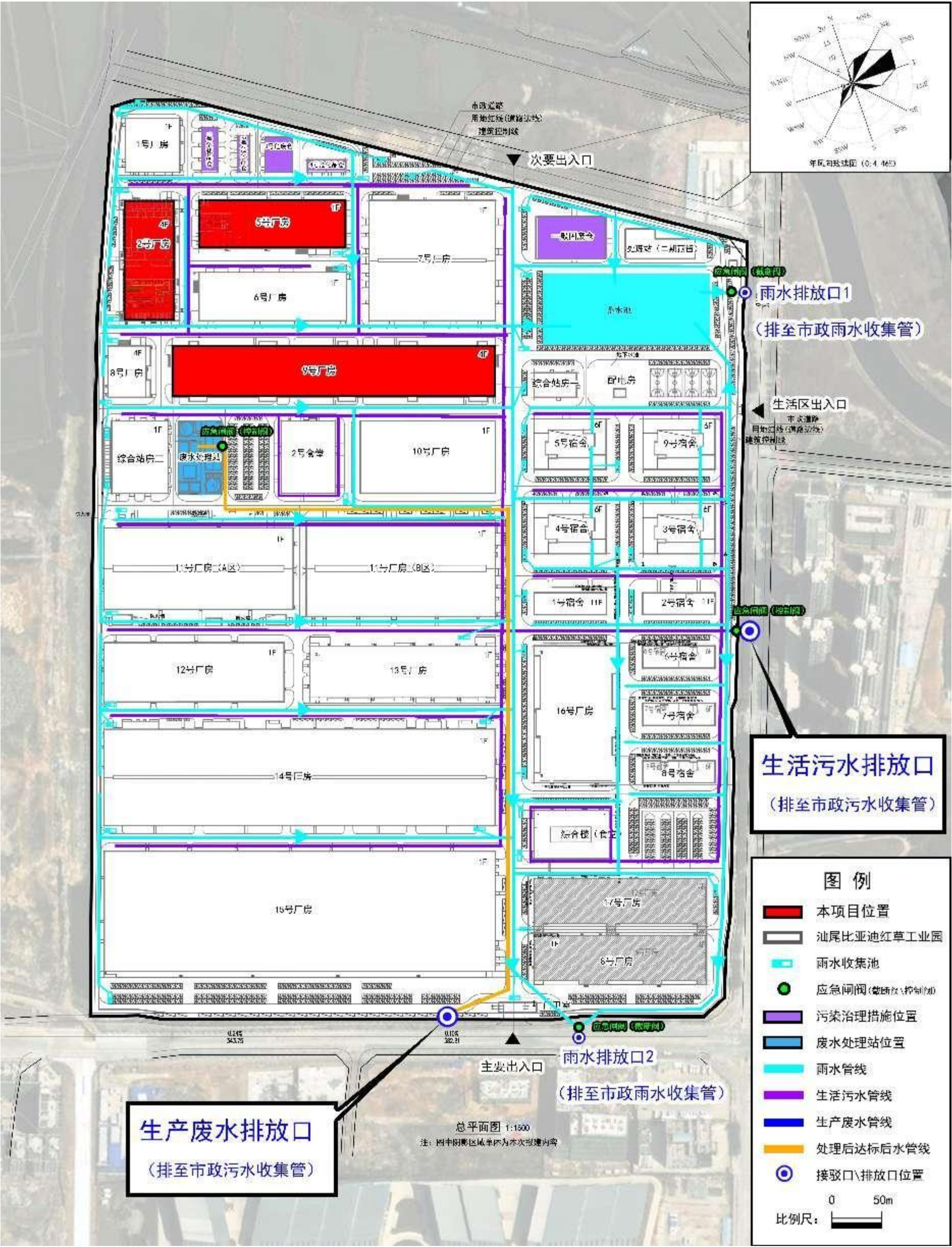
图 3.2-11 厂区内雨污水管网图
