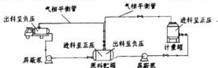
附图 气相平衡管原理图
