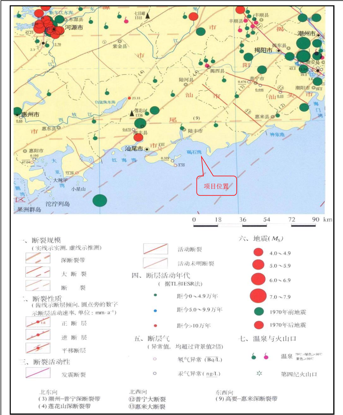
图 2.2.3-1 项目附近断裂分布图（广东省地震局，2000）
