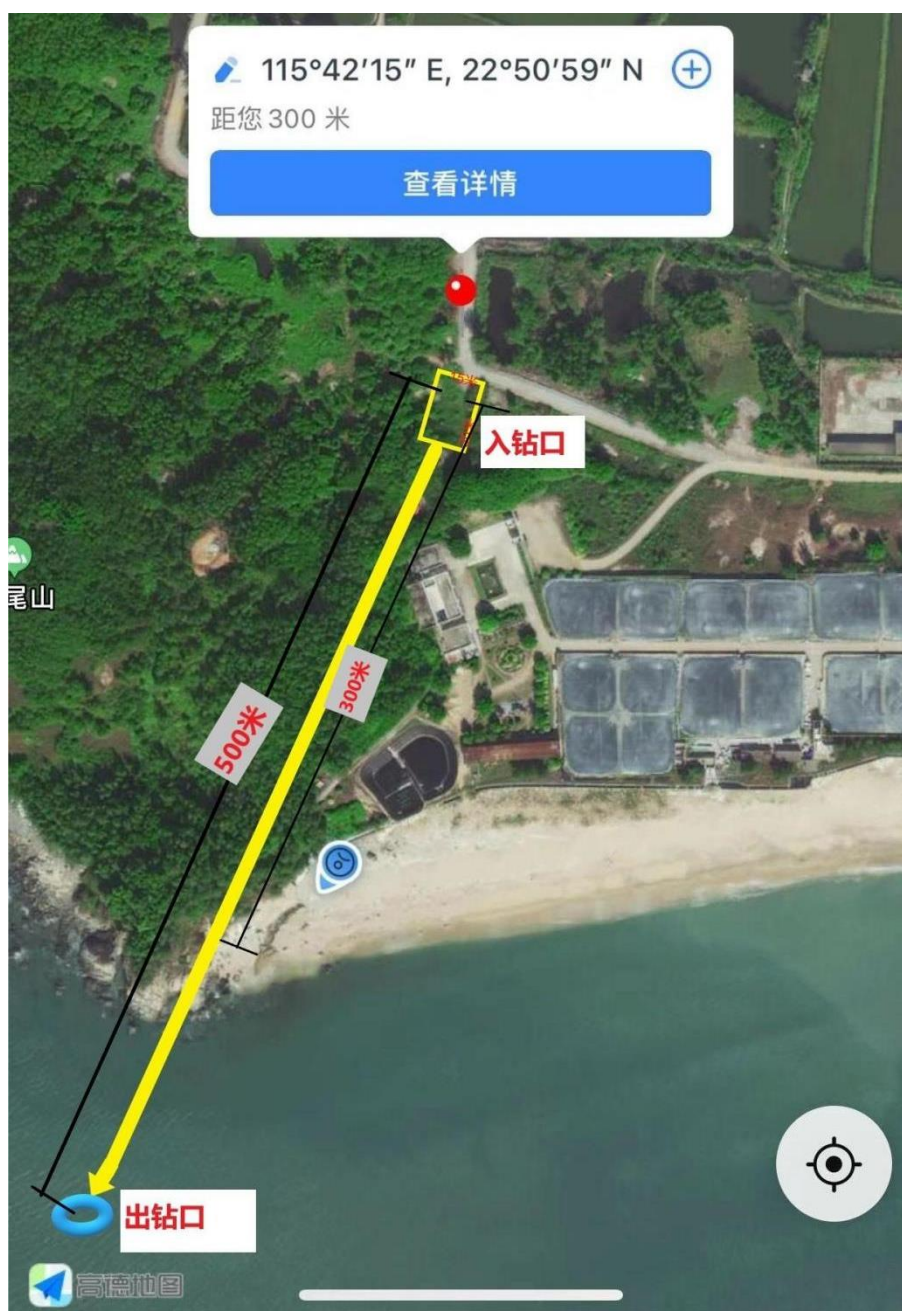
图 1.4.3-6 定向钻剖面施工示意图
